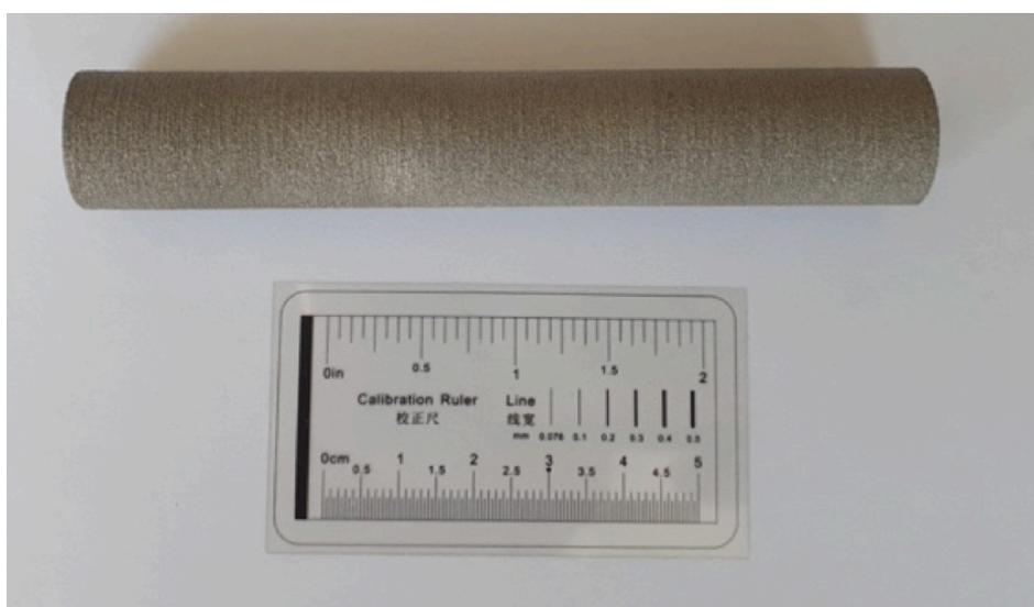
Slika 7.1. Uzorak proizveden aditivnom proizvodnjom u polaznom stanju
