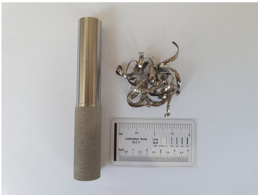
Slika 8.3. Fino tokaren uzorak S3
