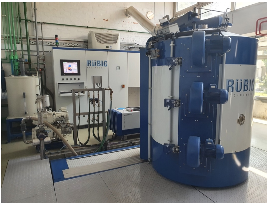
Slika 7.4. Postrojenje za PACVD postupak
