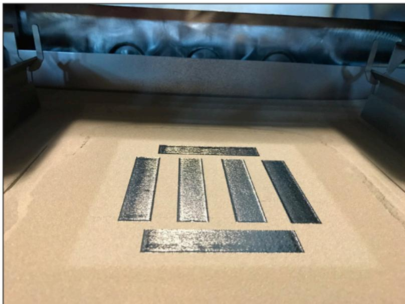
*Slika 3.3. Jednostavne komponente za optimiranje parametara taljenja [5]*
