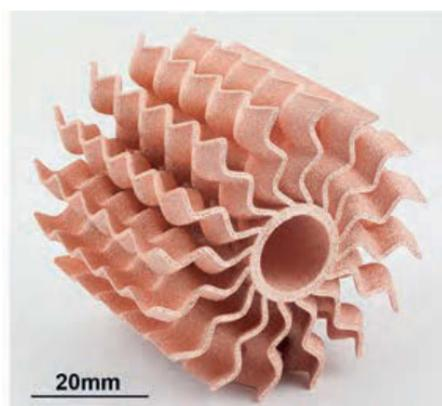
*Slika 3.5. Prototip izmjenjivača topline izrađenog od čistog bakra [7]*
