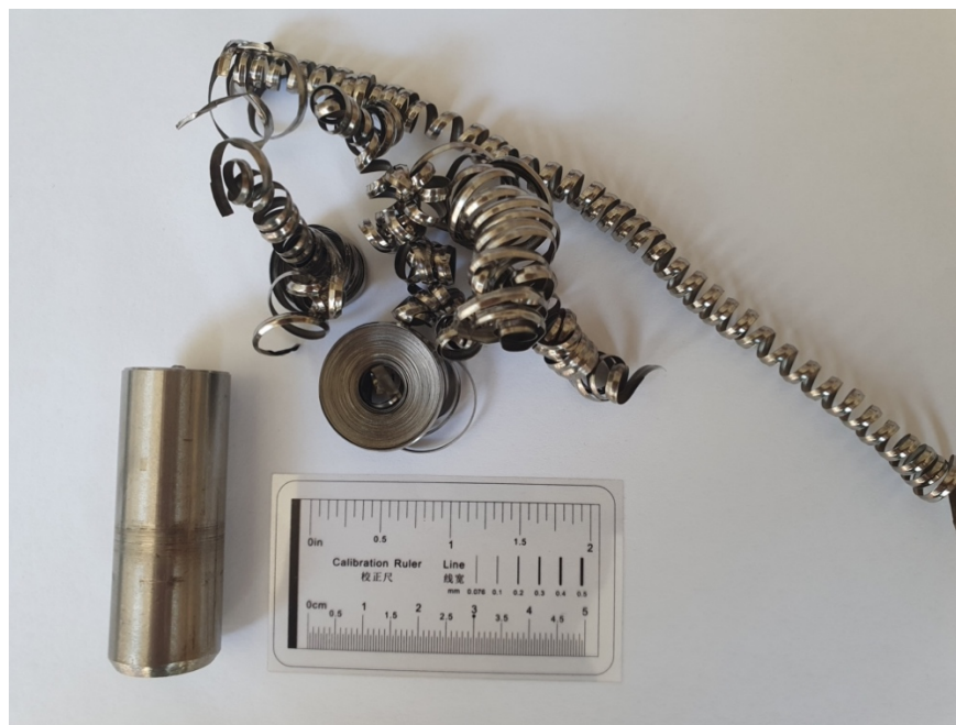
Slika 8.4. Fino tokaren uzorak K1
