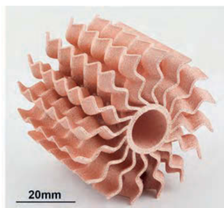
Slika 3.5. Prototip izmjenjivača topline izrađenog od čistog bakra [7]
