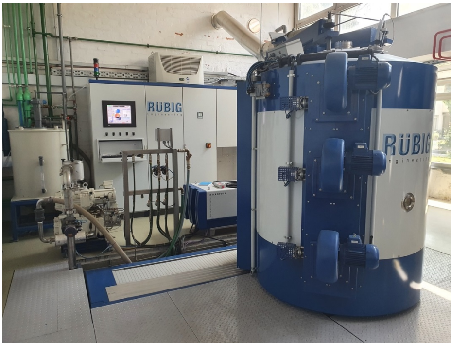
Slika 7.4. Postrojenje za PACVD postupak
