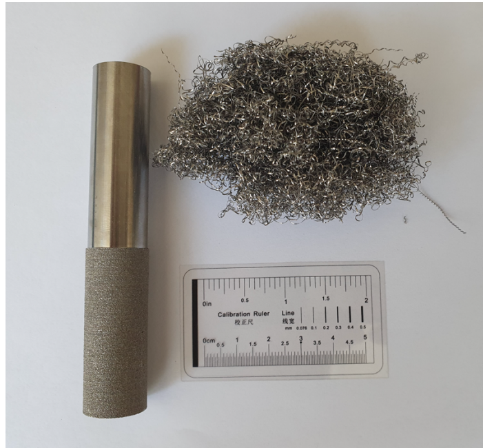
Slika 8.1. Fino tokaren uzorak S1
