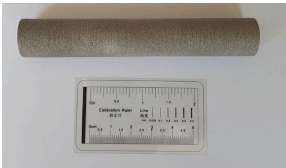
Slika 7.1. Uzorak proizveden aditivnom proizvodnjom u polaznom stanju
