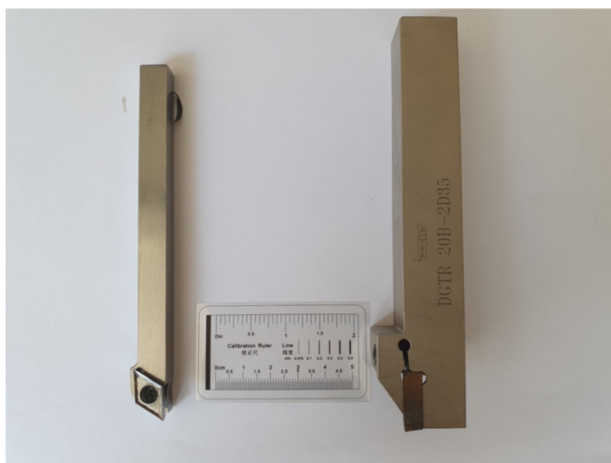
Slika 7.3. Noževi za finu obradu i rezanje na držaču
