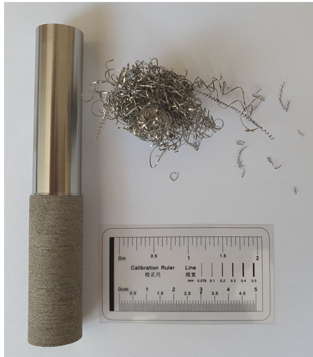
Slika 8.2. Fino tokaren uzorak S2
