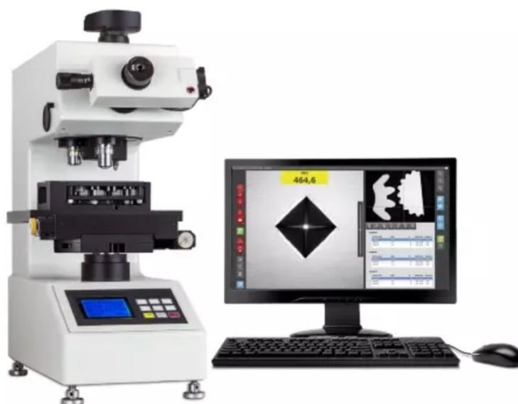
**Tablica 6.2.** Tvrdomjer - uređaj za mjerenje mikrotvrdoće [41]
