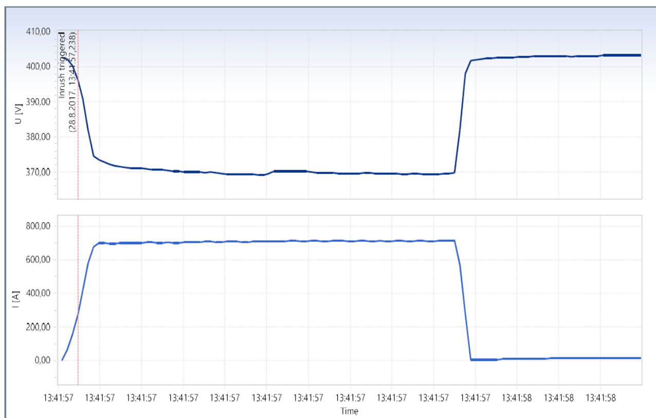
Slika 20. Snimljeni ciklus struje varenja [20]
