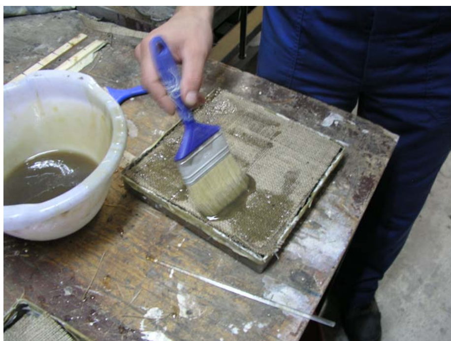
Slika 4.7. Nanošenje UP smole
