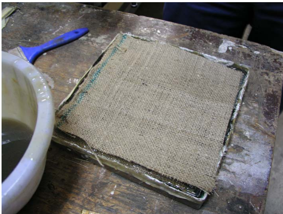
Slika 4.6. Stavljanje sloja jute
