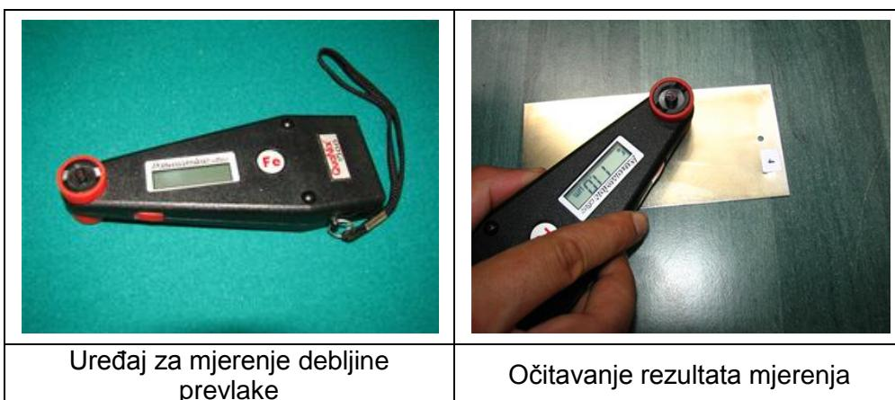
**Slika 14.** Mjerenje uređajem za mjerene debljine prevlake
