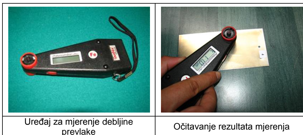
Slika 14. Mjerenje uređajem za mjerenje debljine prevlake
