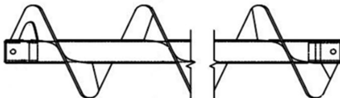
**Slika 20. Zavarena izvedba pužnice [3]**
