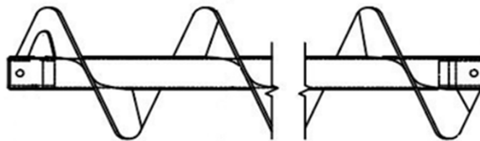
Slika 20. Zavarena izvedba pužnice [3]
