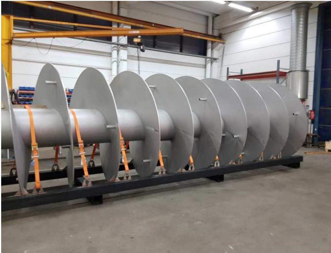
Slika 11. Siirotruuvi velika pužnica dimenzija  $\text{Ø}2075 \times 12125$  [5]
