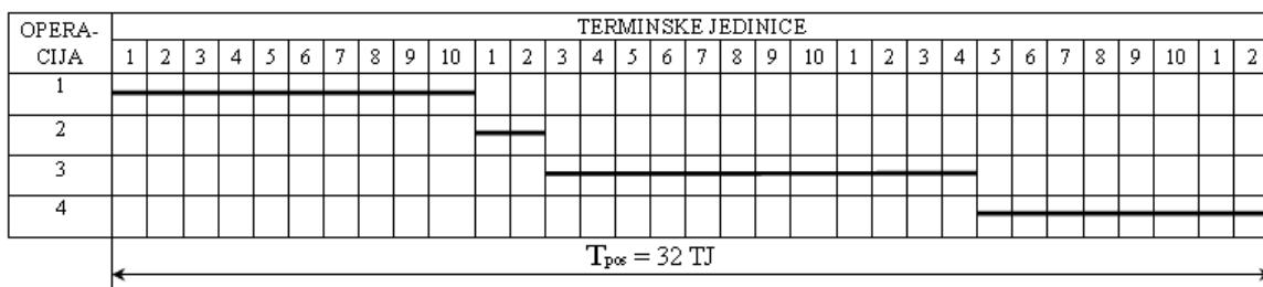
Slika 2. Gantogramski prikaz postupnog ciklusa proizvodnje, [4]
