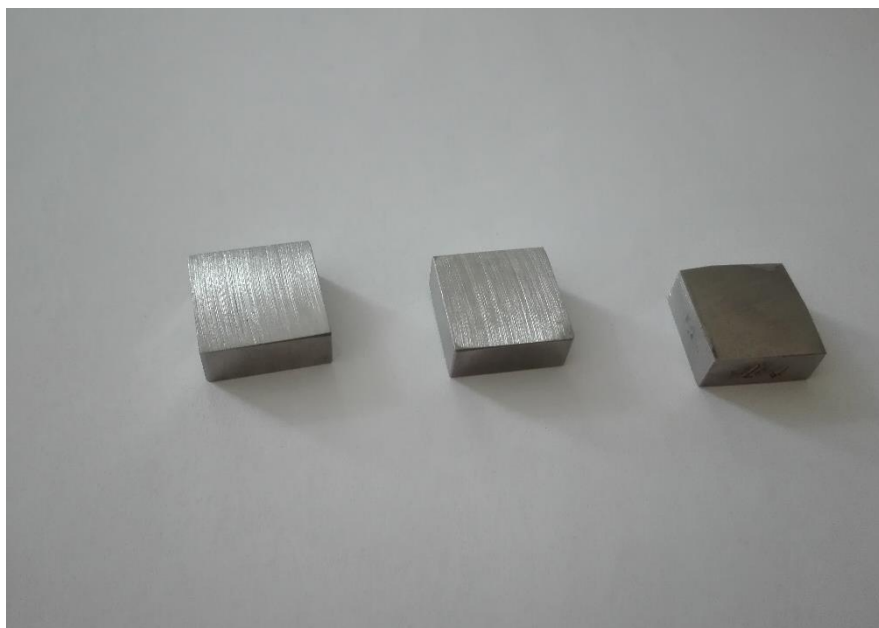
Slika 16. Ispitni uzorci prije provedenog prevlačenja
