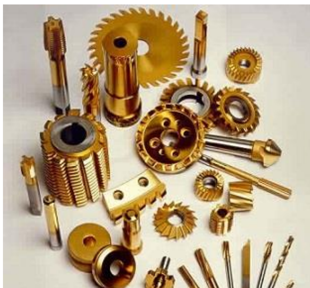
Slika 11. Rezni alati prevučeni slojem TiN [12]
