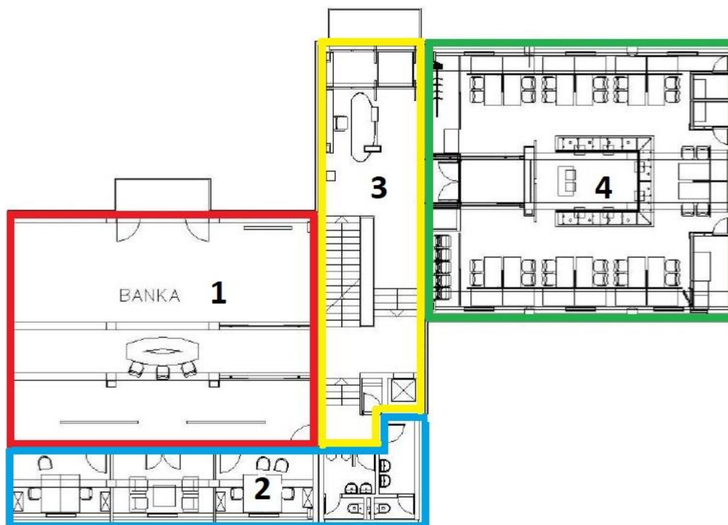
Slika 14 Pojednostavljeno zoniranje prizemlja uredske zgrade
