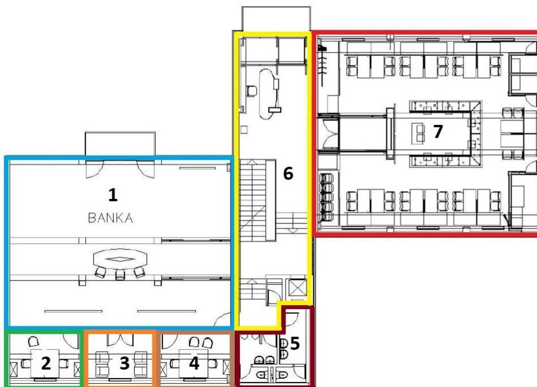
Slika 10 Složeno zoniranje prizemlja uredske zgrade
