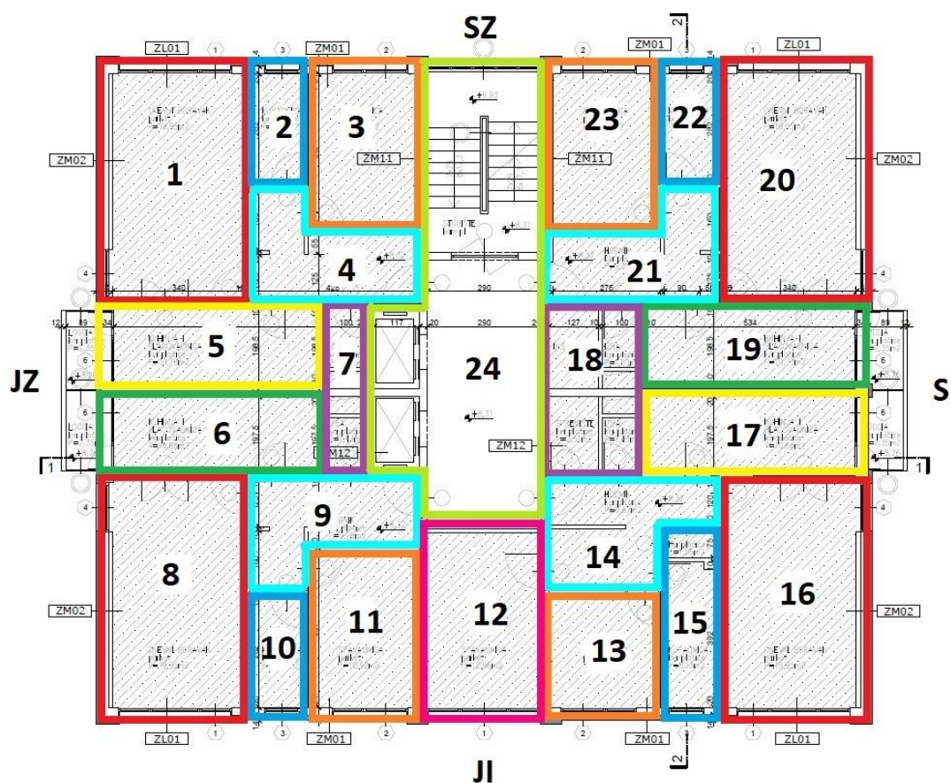
Slika 7 Složeno zoniranje karakterističnog kata stambene zgrade
