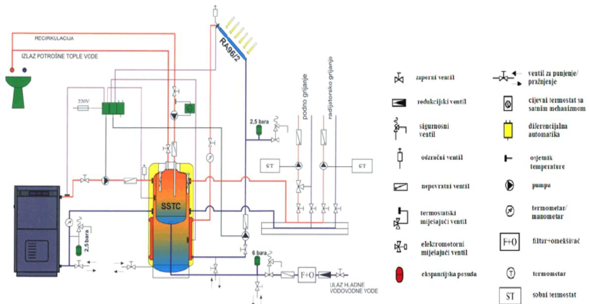
Slika 4. Solarni toplovodni sustav sa dvostrukim spremnikom [6]
