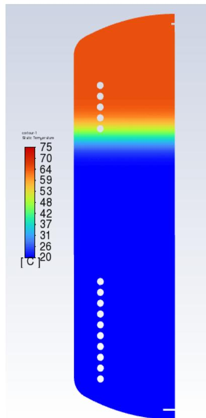
Slika 16. Temperaturna raspodjela nakon 75 min rada
