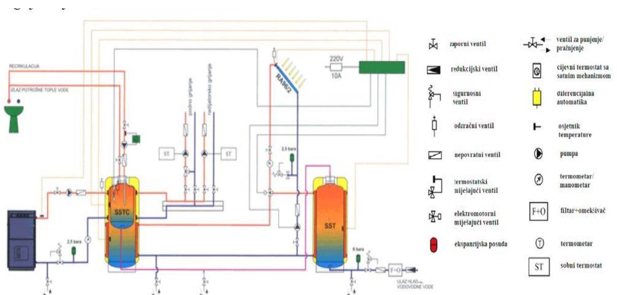
Slika 5. Solarni toplovodni sustav sa dva spremnika [6]
