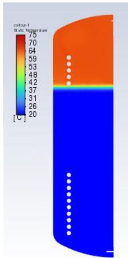
**Slika 13.** Temperaturna raspodjela nakon 15 min rada pomoćnog grijača
