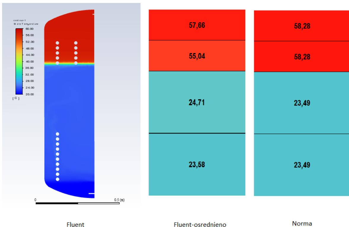
**Slika 26. Grafička usporedba rezultata simulacije s rezultatima prema normi za t=25 min**
