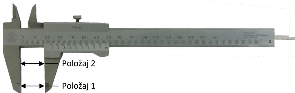
Slika 3 Paralelnost mjernih površina za vanjska mjerena
