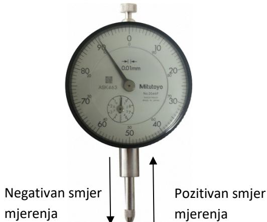
Slika 5 Mjerna ura - smjerovi mjerena
