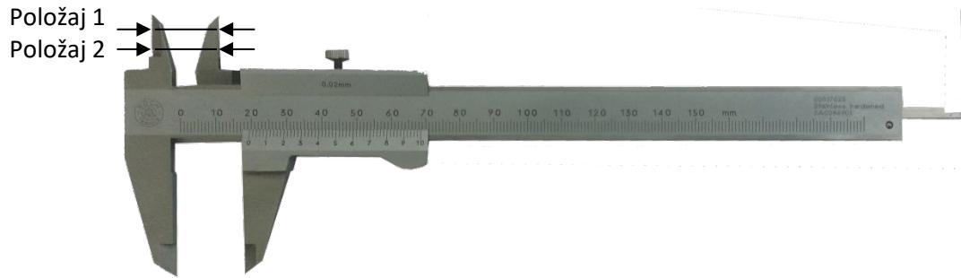
Slika 2 Paralelnost mjernih površina za unutarnja mjerena
