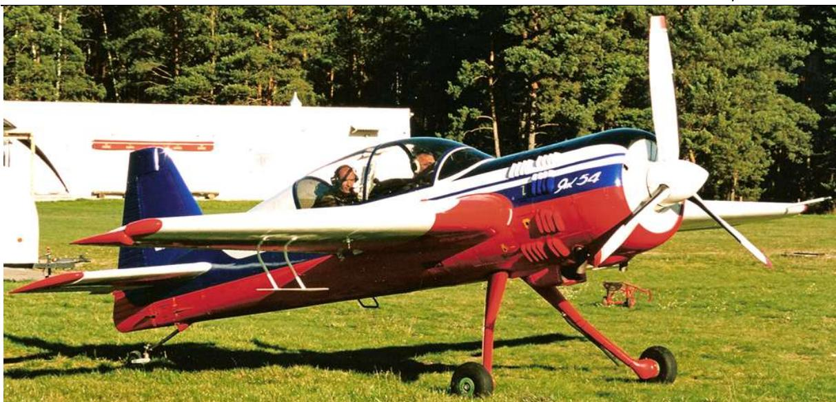
Slika 6. Sportski zrakoplov Jakovlev Jak-54 s deveterocilindričnim zvjezdastim motorom [8]
