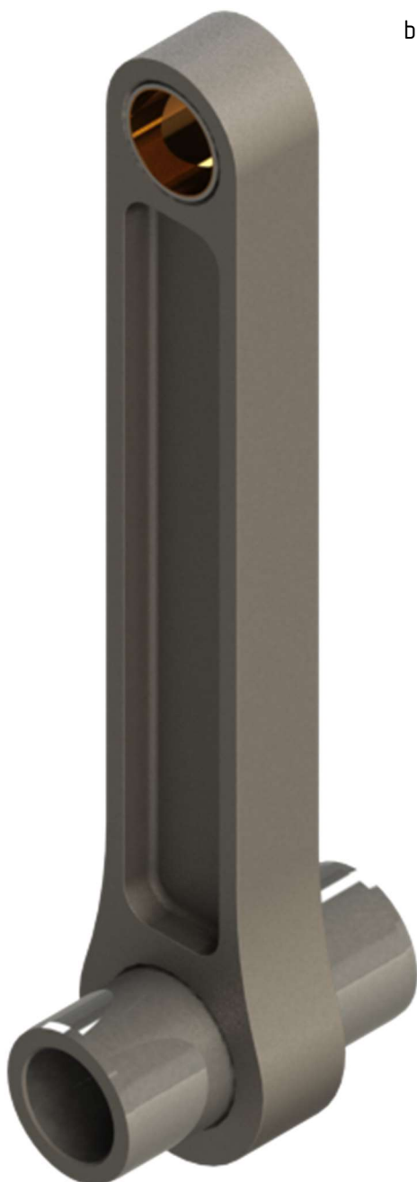
Slika 87. Klipnjača s osovinicom i ležajem male glave u a) aksonometriji i b) aksonometriji punog presjeka
