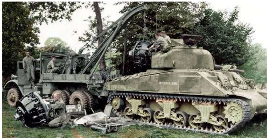
Slika 2. Servisiranje zvjezdastog motora Wright R-975 američkog tenka M4 [4]
