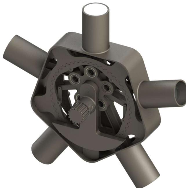
Slika 125. Izometrijski prikaz dovršenog sklopa klipnog mehanizma
