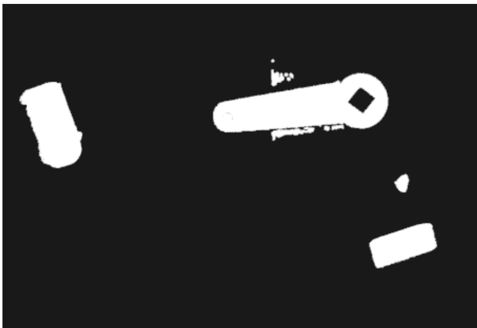
Slika 60. Oblak točaka prije euklidske klasterizacije
