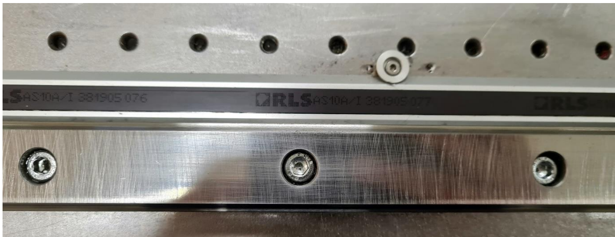
Slika 32. RLS magnetna traka postavljena u laboratoriju
