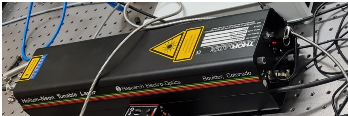
Slika 27. Thorlabs HTPS-EC-1 HeNe laser
