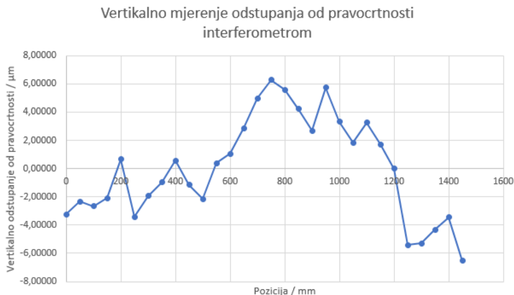
Slika 44. Graf vertikalnih odstupanja od pravocrtnosti mjerenih interferometrom
