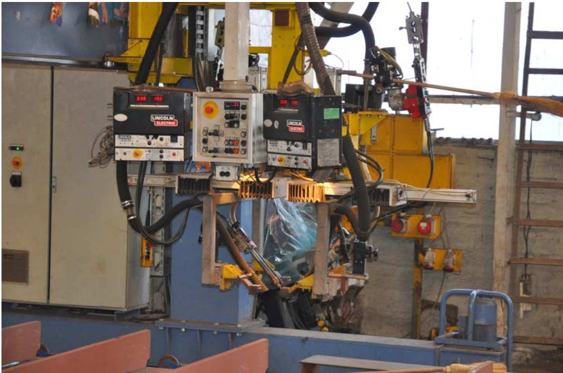
Slika 33. Dio opreme za reguliranje parametara i upravljanje strojem za EPP zavarivanje, Brodogradilište Uljanik, Pula
