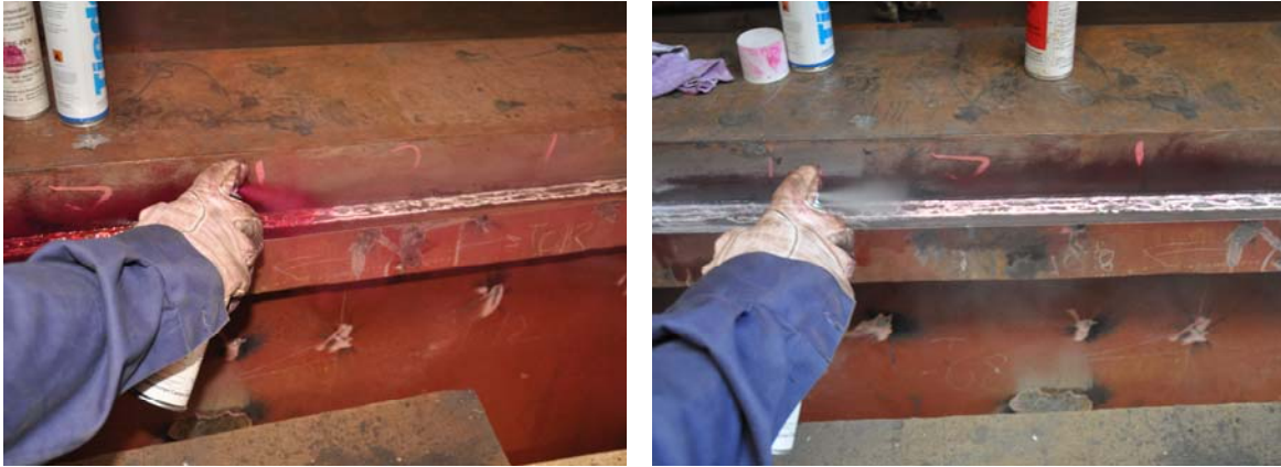
Slika 37 i 38. Nanošenje „crvenog” penetranta, te potom „bijelog” razvijачa, Brodogradilište Uljanik, Pula
