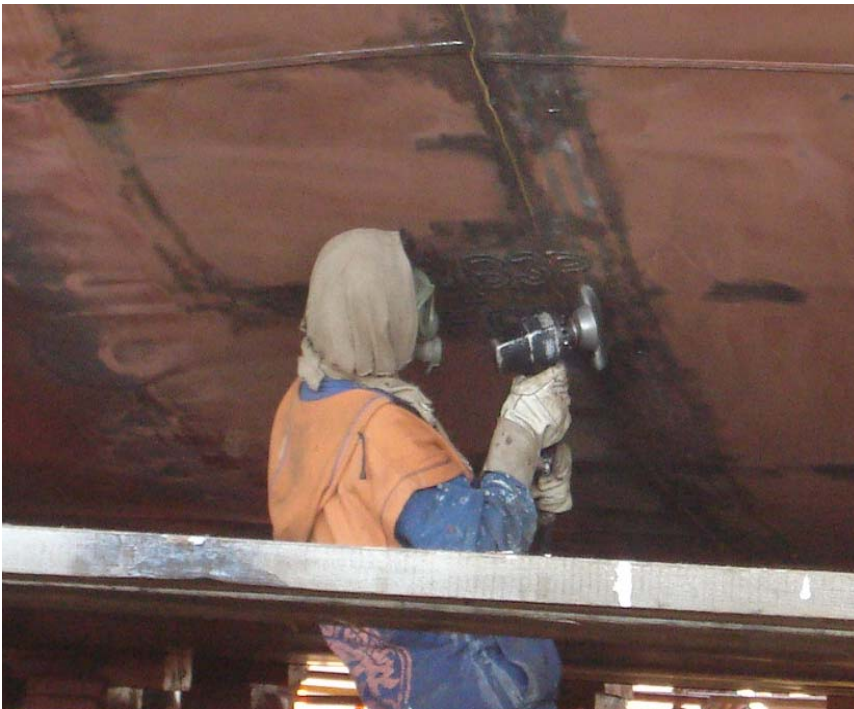
Slika 62. Obrada i čišćenje montažnog spoja "steel work", Brodogradilište Uljanik, Pula
