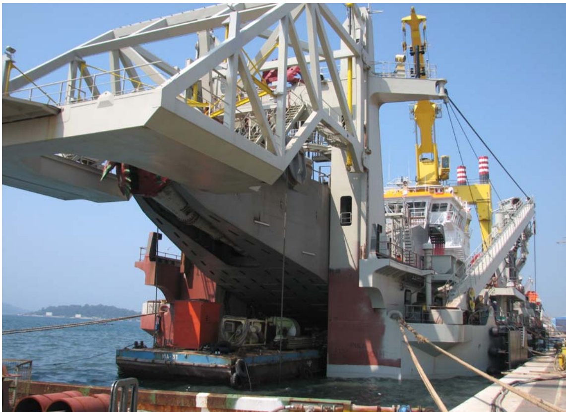
Slika 83. Kopač u trenutku popravka silikonskog premaza, Brodogradilište Uljanik, Pula
