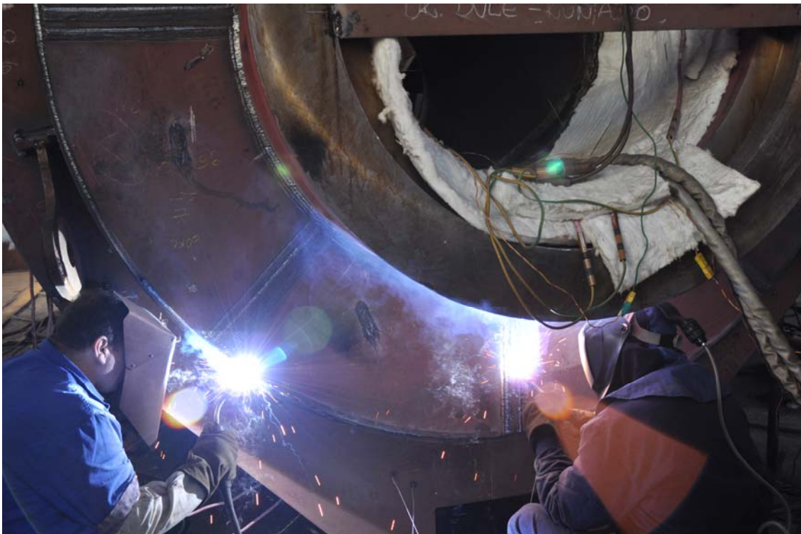
Slika 29. Zavarivanje REL i MIG postupkom, gdje se zavaruje „glava” kopača praškom punjenom žicom \varnothing 1.2 mm, te elektrodom \varnothing 5 mm. Debljina materijala koji se zavaruje je 30 mm, te se za te debljine koristi žica i elektroda koje sadrži veći postotak nikla radi bolje zavarljivosti. Prilikom zavarivanja, lim se predgrijava elektro – induktivnim predgrijavanjem na temperaturu od 160^{\circ}\text{C} , Brodogradilište Uljanik, Pula, svibanj 2010.
