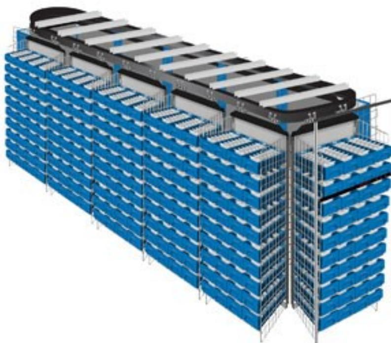
Slika 24. Primjer horizontalnog karusela [65]
