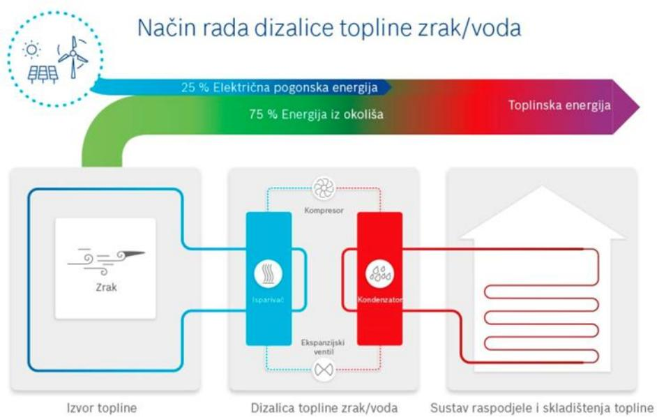
**Slika 3. Shema dizalice topline zrak-voda**
