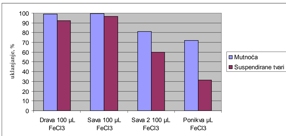
Slika 20. Uklanjanje suspendiranih tvari koagulacijom flokulacijom, taloženjem, filtracijom
