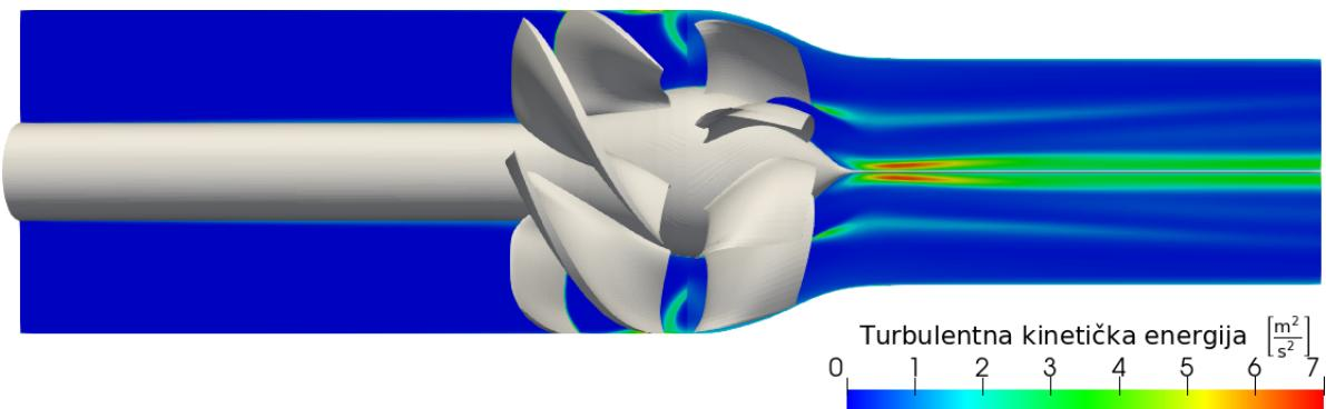
Slika 4.14: Polje turbulentne kinetičke energije hidromlaznice; 1 harmonik.
