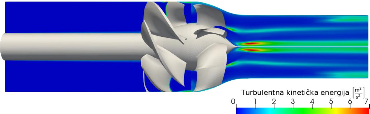
Slika 4.16: Polje turbulentne kinetičke energije hidromlaznice; 5 harmonika.
