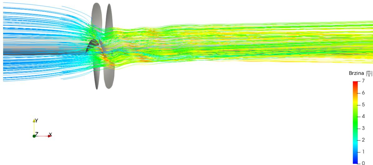
Slika 5.21: Prikaz strujnica fluida u interakciji kontrarotirajućih propelera.
