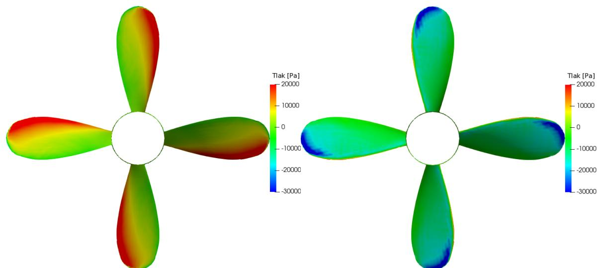
Slika 5.12: Raspodjela tlaka pretlačne strane *aftProp* propelera (lijevo) i potlačne strane (desno); harmonička ravnoteža.
