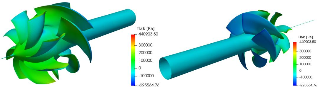
Slika 4.10: Pretlačna i potlačna strana hidromlaznice za 1 harmonik.
