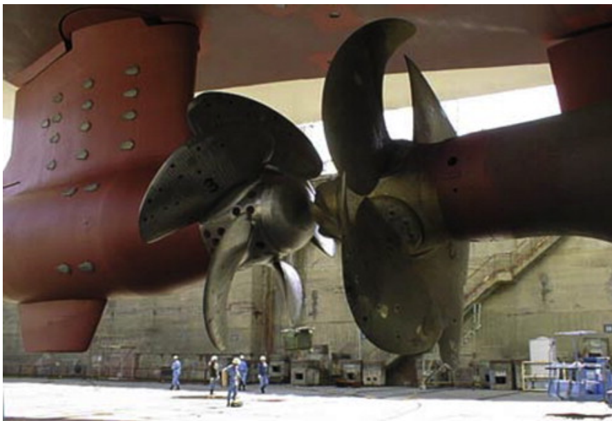
Slika 5.1: Primjer kontrarotirajućih propelera [1].
