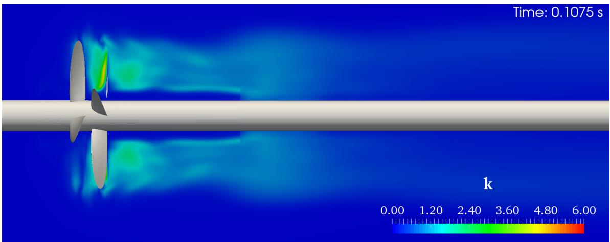
Slika 5.27: Polje turbulentne kinetičke energije u presjeku ravnine  $z = \text{konst.}$ ; tranzijentna simulacija [1].
