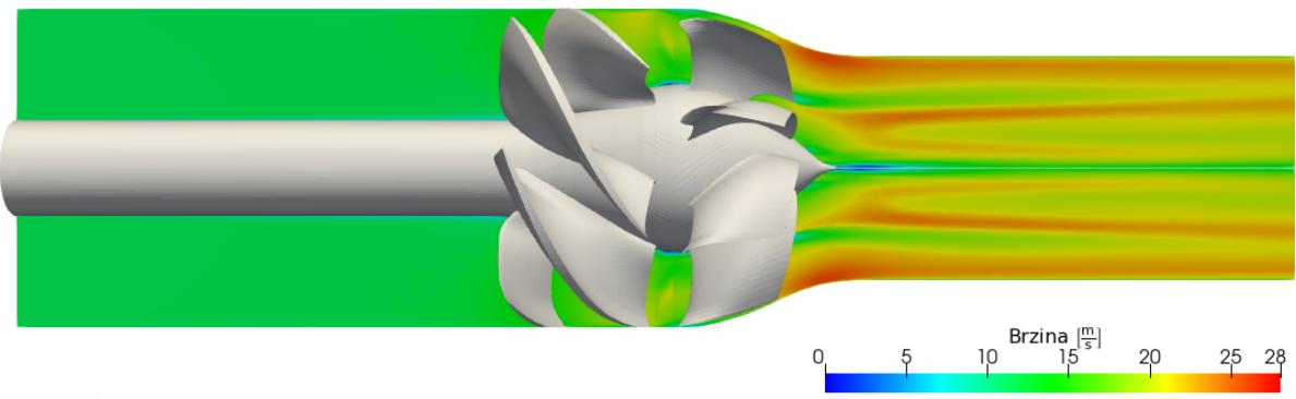
Slika 4.5: Polje brzine hidromlaznice; MRF simulacija.
