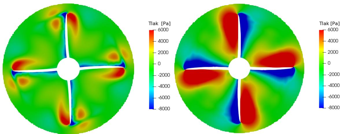
Slika 5.16: Lokalna promjena tlaka na presjecima (lijevo prednji propeler, desno stražnji) ravnine  $x = \text{konst.}$ ; harmonička ravnoteža.
