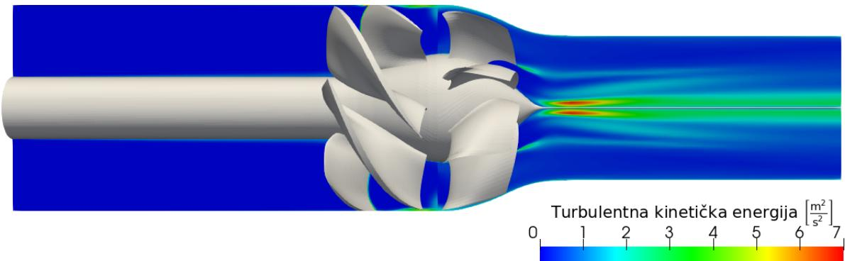
Slika 4.15: Polje turbulentne kinetičke energije hidromlaznice; 3 harmonika.
