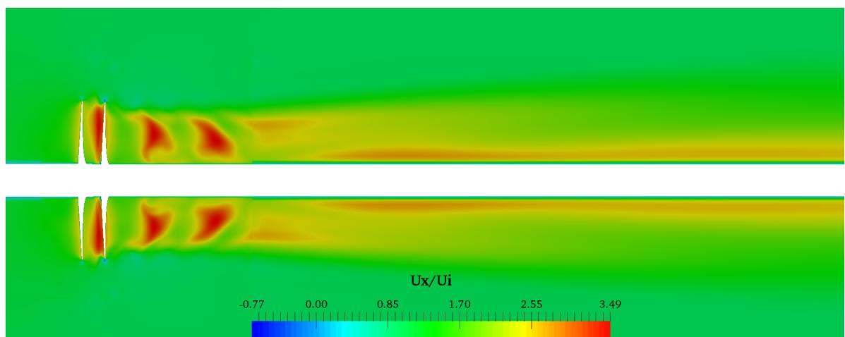
Slika 5.20: Odnos ulazne i aksijalne brzine u ravnini  $z = \text{konst.}$ ; MRF simulacija [1].
