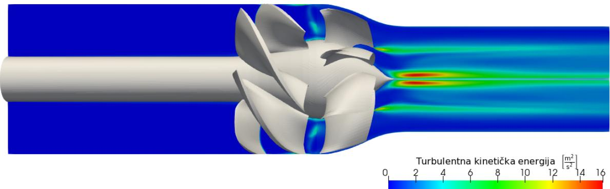
Slika 4.17: Polje turbulentne kinetičke energije hidromlaznice; MRF simulacija.
