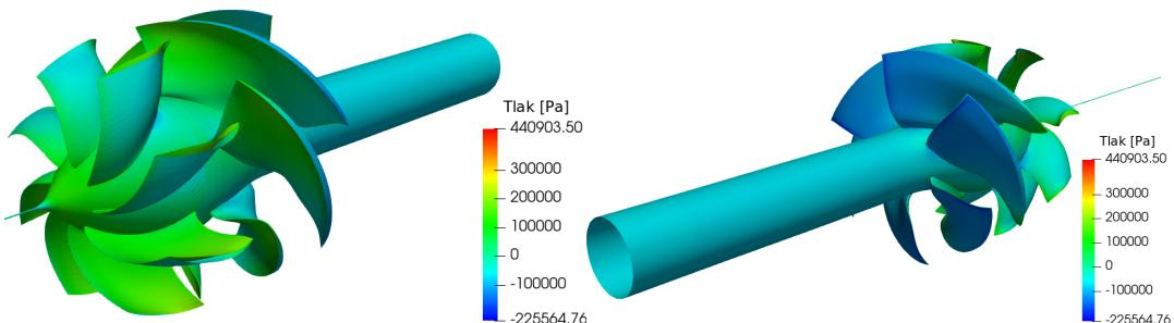
Slika 4.11: Pretlačna i potlačna strana hidromlaznice za 3 harmonika.
