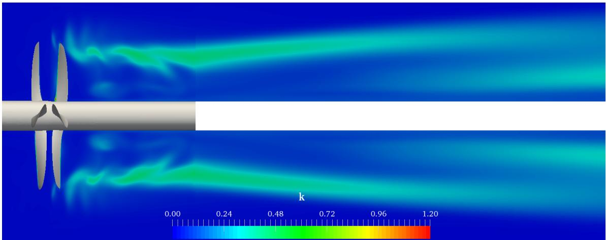
Slika 5.26: Polje turbulentne kinetičke energije u presjeku ravnine  $z = \text{konst.}$ ; MRF simulacija [1].
