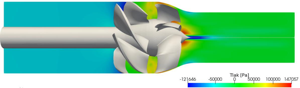
Slika 4.9: Polje tlaka hidromlaznice; MRF simulacija.
