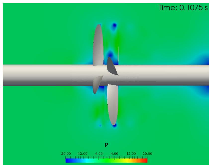
Slika 5.10: Polje tlaka kontrarotirajućih propelera u  $z = \text{konst.}$  ravnini; tranzijentna simulacija [1].
