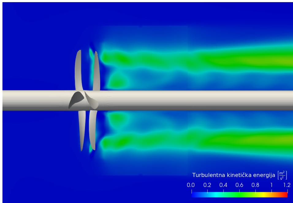
Slika 5.25: Polje turbulentne kinetičke energije u presjeku ravnine  $z = \text{konst.}$ ; harmonička ravnoteža.
