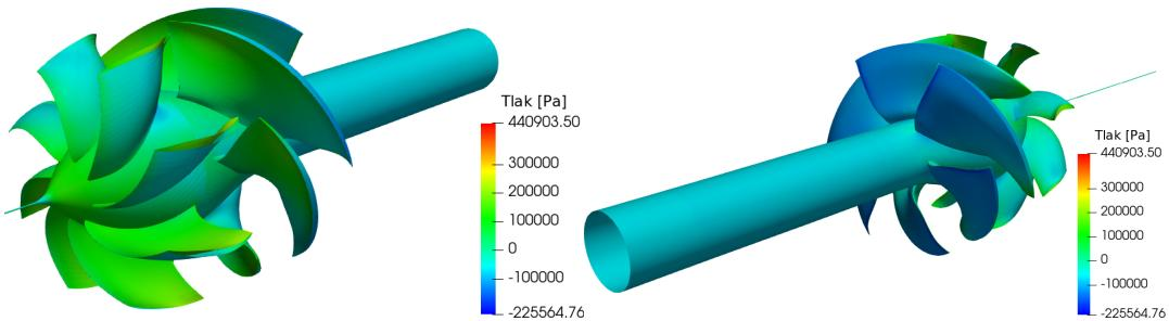
Slika 4.12: Pretlačna i potlačna strana hidromlaznice za 5 harmonika.
