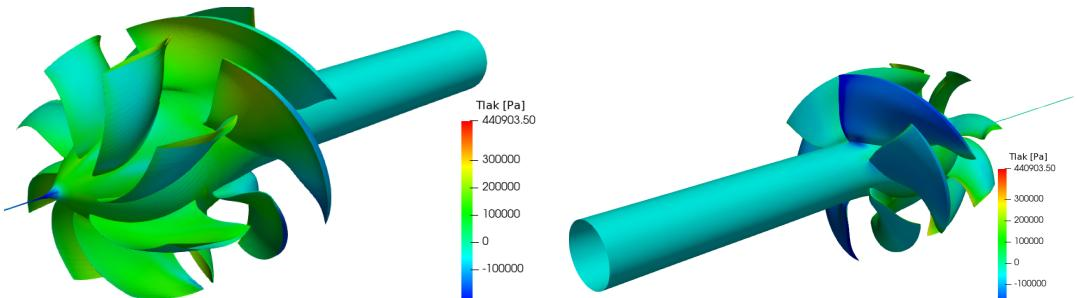
Slika 4.13: Pretlačna i potlačna strana hidromlaznice MRF simulacije.
