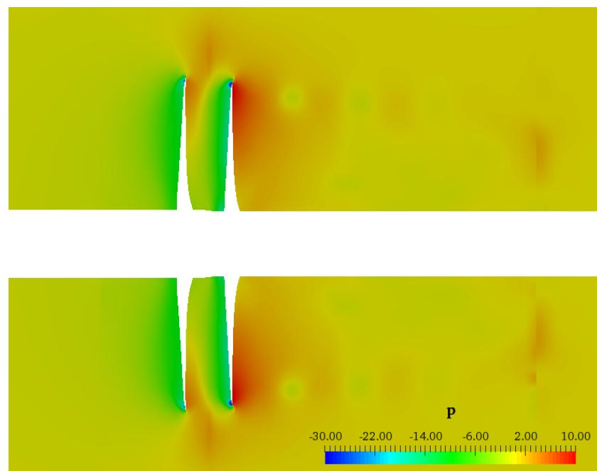
Slika 5.9: Polje tlaka kontrarotirajućih propelera u  $z = \text{konst.}$  ravnini; MRF simulacija [1].
