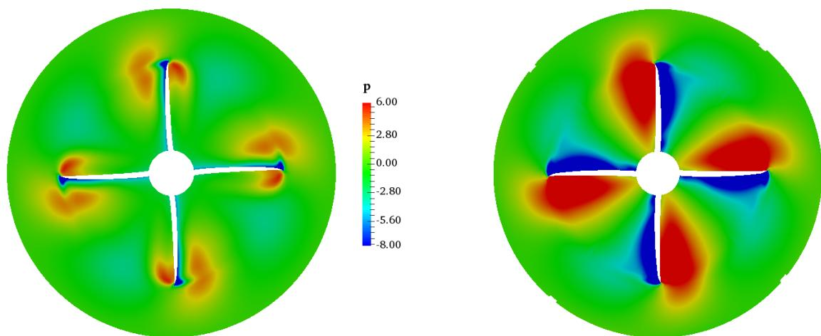
Slika 5.17: Lokalna promjena tlaka na presjecima (lijevo prednji propeler, desno stražnji) ravnine  $x = \text{konst.}$ ; MRF simulacija [1].
