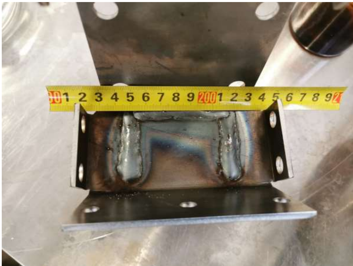
Slika 26 Zavareni spoj izveden u Laboratoriju za zavarivanje na
