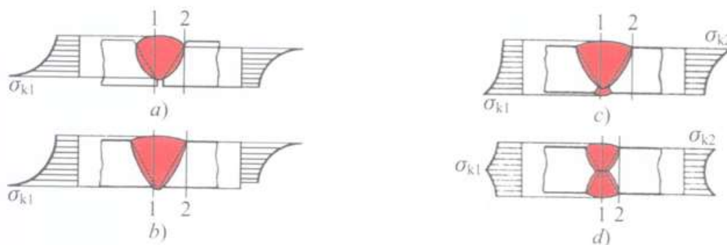
Slika 11 Podjela napreznja u sučeljenom spoju ( \sigma_k - zarezno djelovanje)
