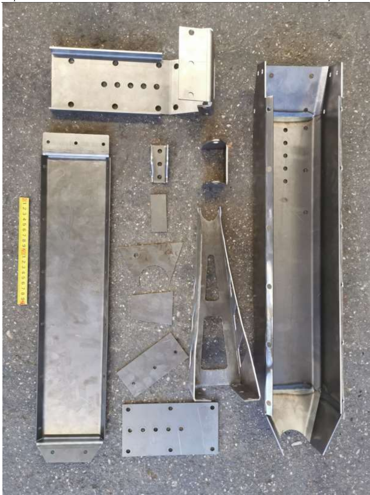
Slika 16 Komponente za izradu okvira električnog bicikla Thor, pogled odozgo
