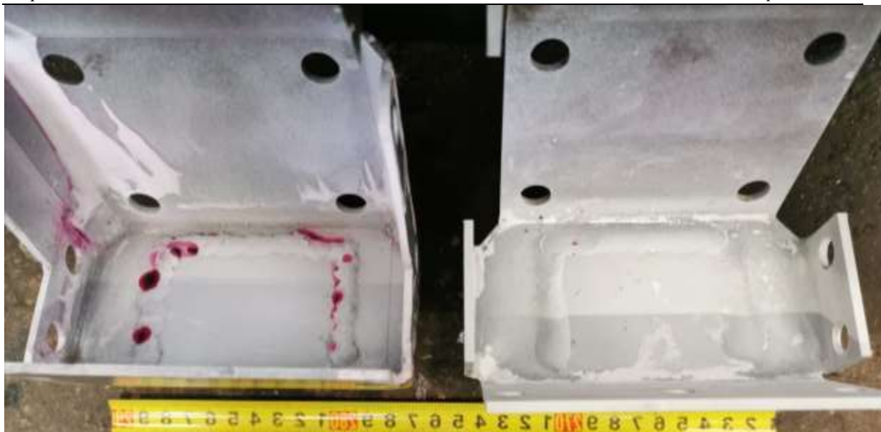
Slika 30 Indikacije na površini zavarenih spojeva
