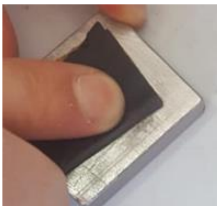
Slika 31. Postupak brušenja ispitnog uzorka brusnim papirom
