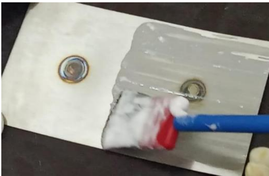
Slika 10. Prikaz kemijske obrade zavara nagrizanjem [5]
