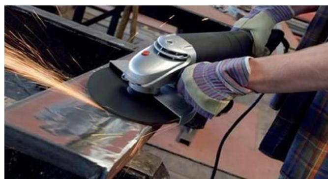
Slika 9. Prikaz mehaničke obrade zavara brušenjem [13]
