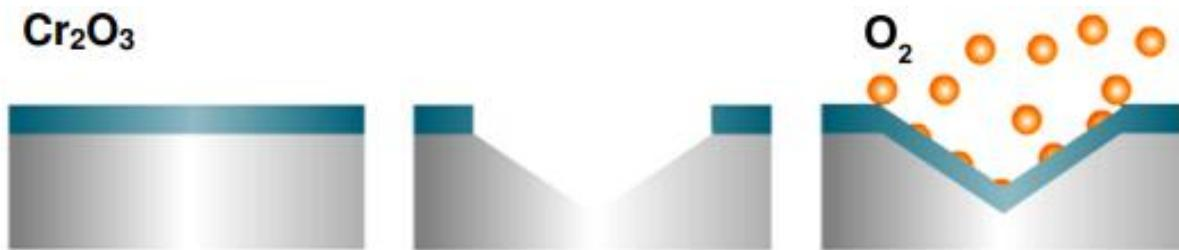
**Slika 3. Shematski prikaz repasivacije prilikom oštećivanja metalne površine [2]**
