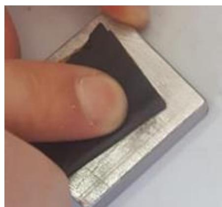
**Slika 31. Postupak brušenja ispitnog uzorka brusnim papirom**
