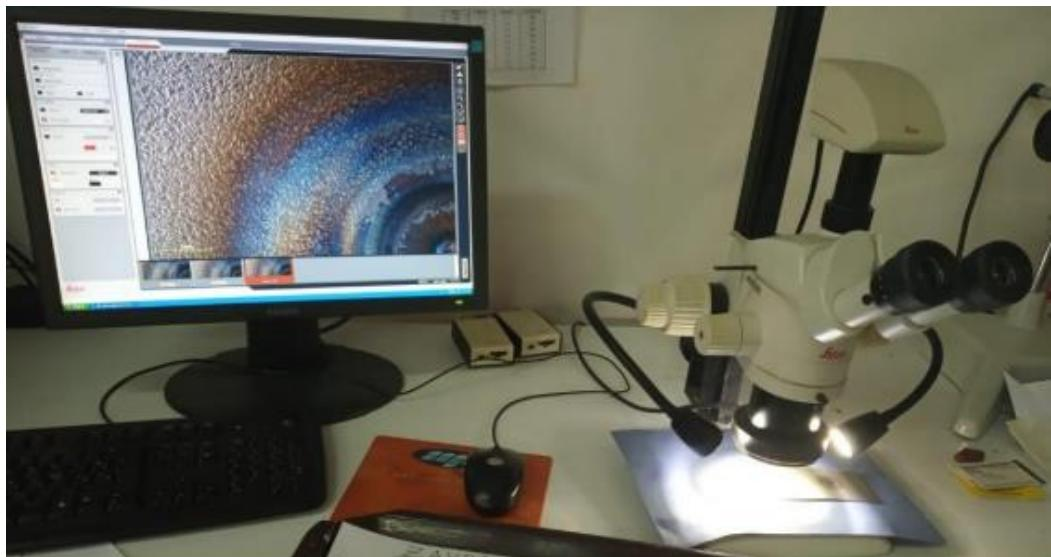
Slika 33. Prikaz stereomikroskopa Leica Mz76
