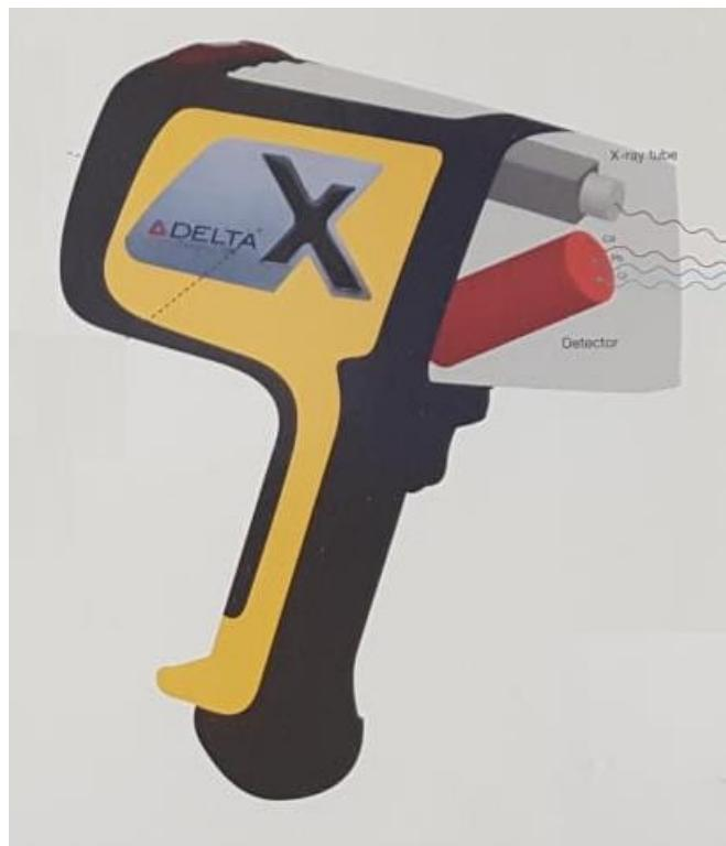
Slika 30. Ilustrirani prikaz uređaja Portable X-Ray Analyzer [37]
