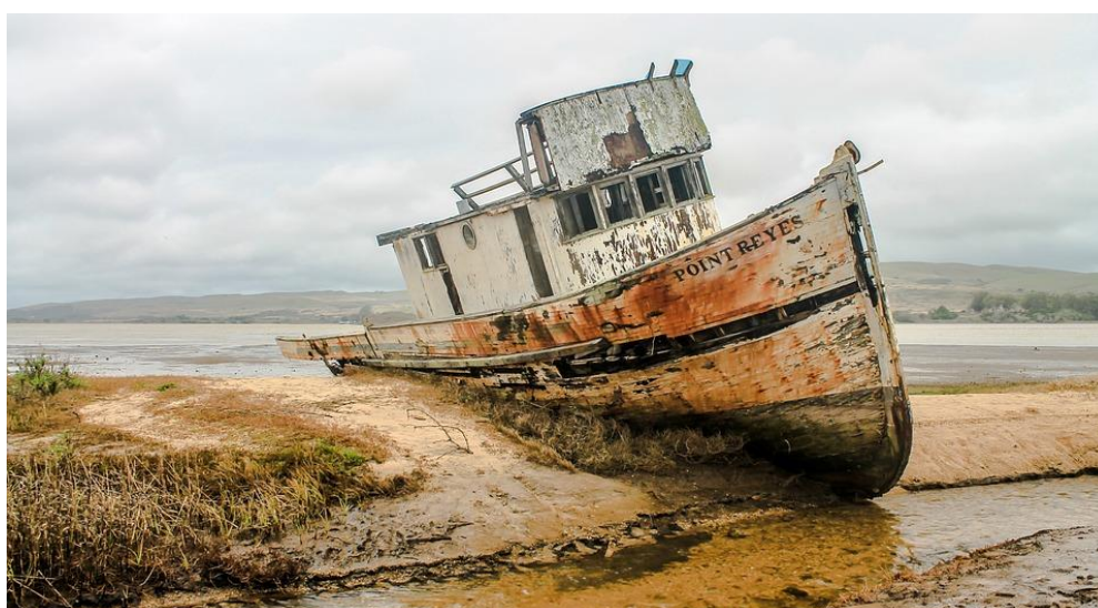
Slika 22. Primjer korozije u morskom okolišu [28]
