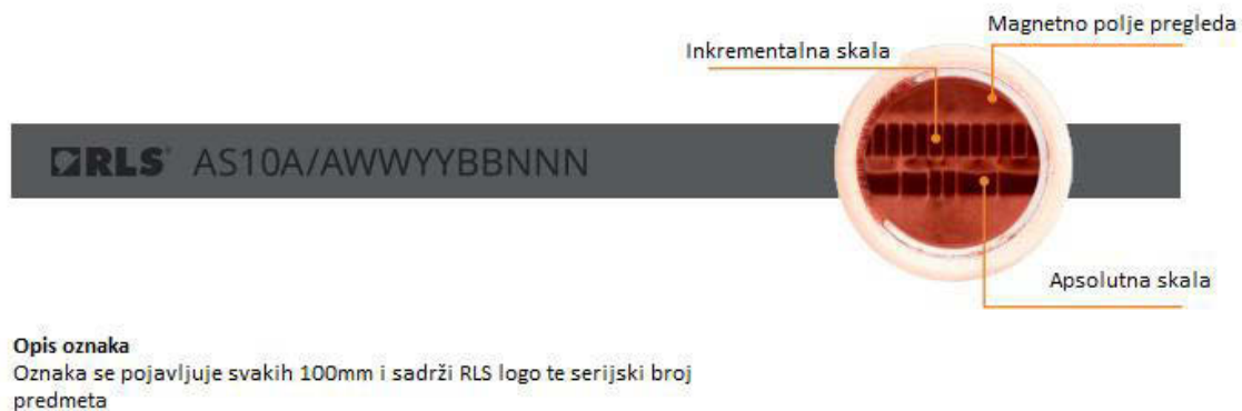
Slika 16. Struktura magnetske trake RLS AS10 [12]
