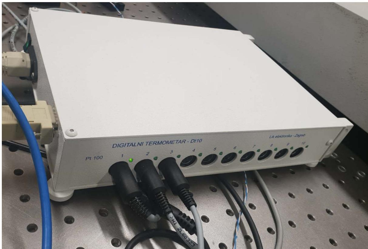
Slika 26. Digitalni termometar Dt10
