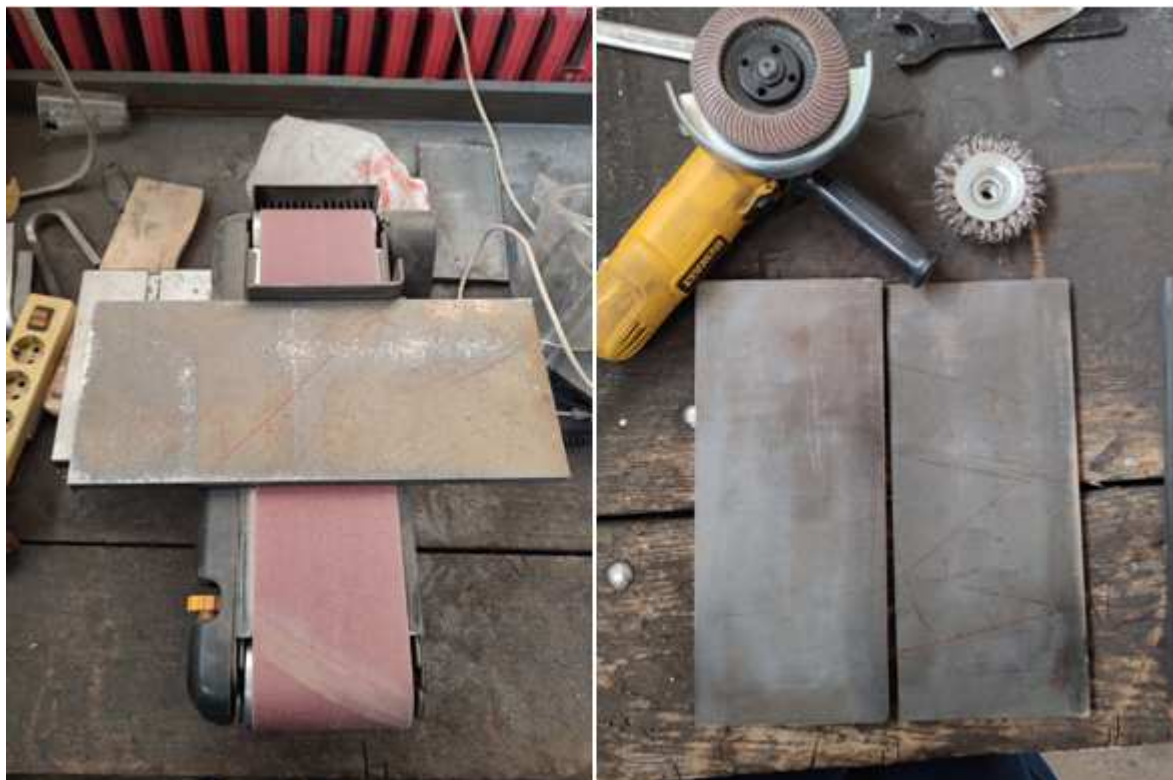
Slika 26. Obrada površine pomoću tračne i kutne brusilice
