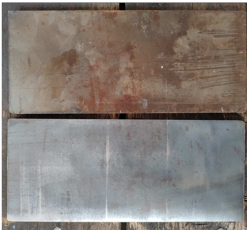
Slika 26. Obrada površine pomoću tračne i kutne brusilice
