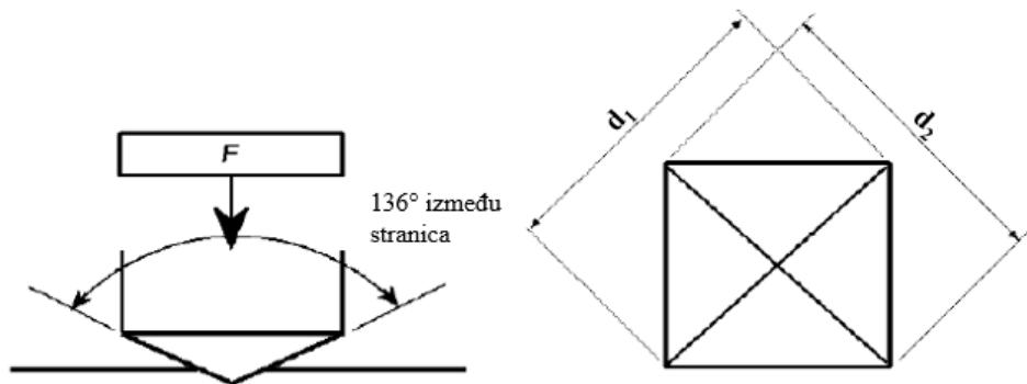
Slika 4.1 Ispitivanje tvrdoće metodom Vickers [23]
