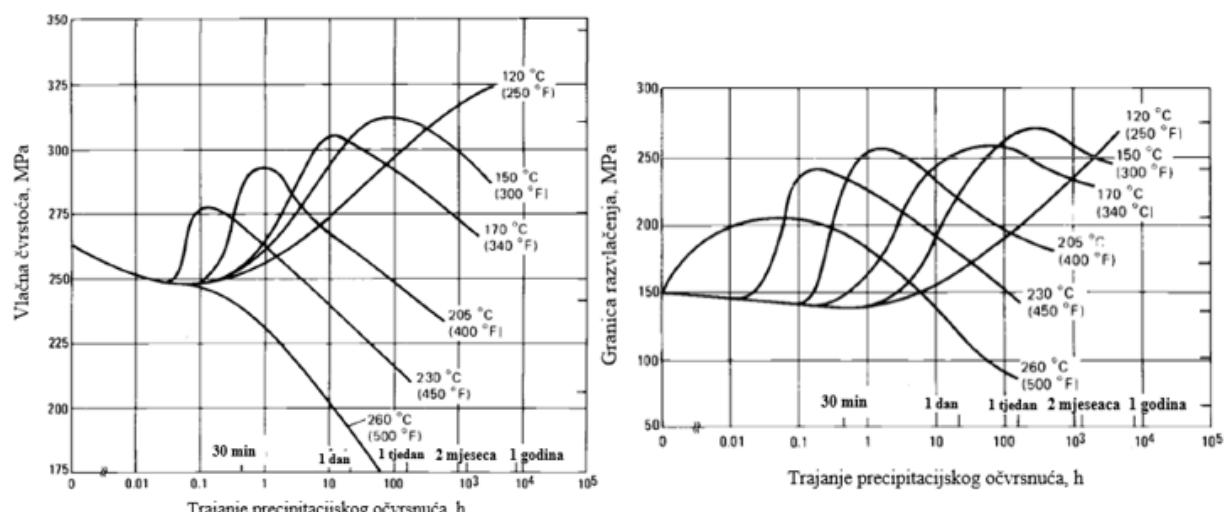
**Slika 3.15 Dijagrami aluminijeve legure 6061 ovisnosti vlačne čvrstoće i granice razvlačenja o trajanju precipitacijskog očvršnoca [7]**
