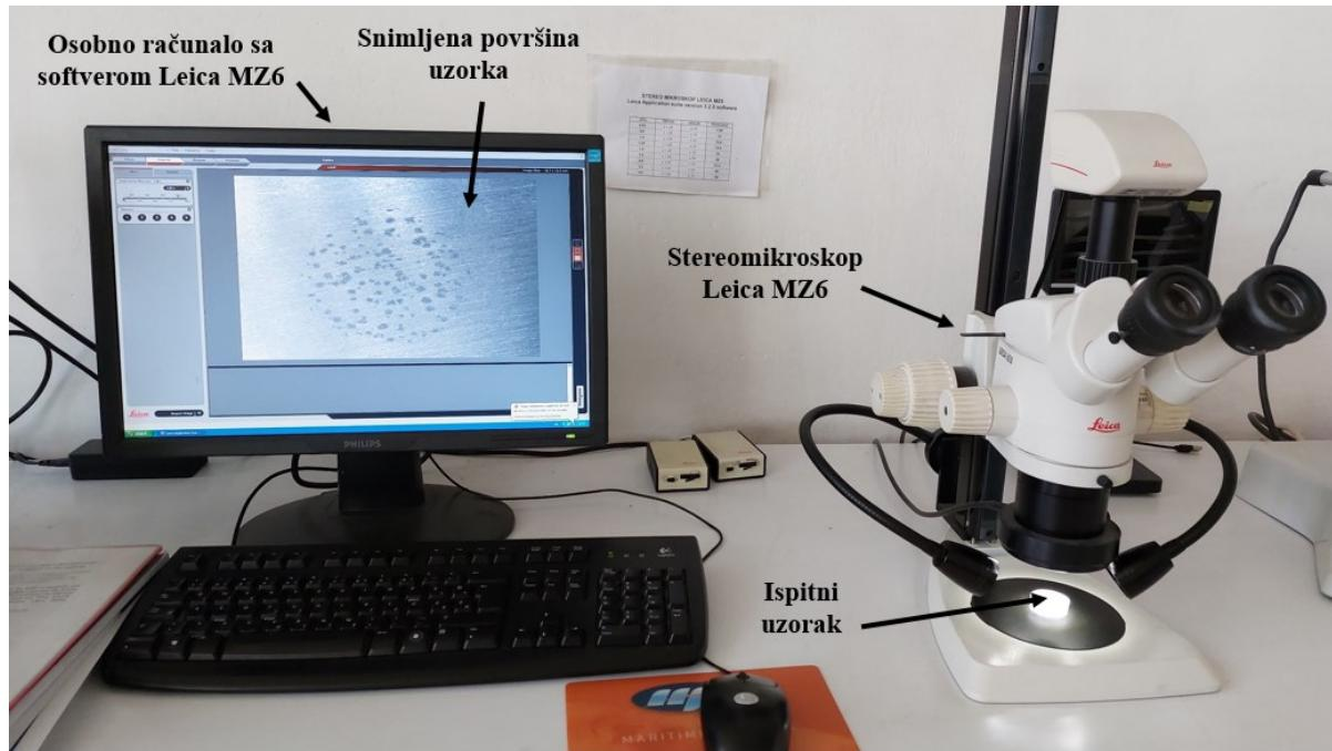
Slika 5.17 Snimanje površine uzorka pomoću stereomikroskopa Leica MZ6
