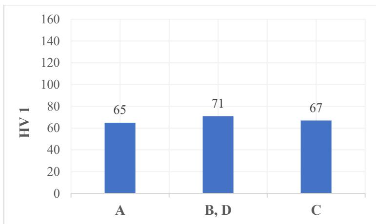
**Slika 6.1 Tvrdoće ispitnih uzoraka nakon rastvornog žarenja**
