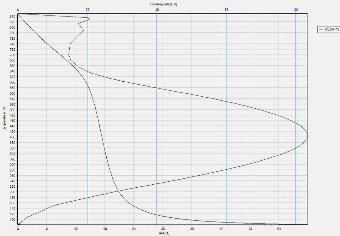
Slika 5.12 Krivulja ohlađivanja i krivulja brzine ohlađivanja u vodi temperature 75 °C
