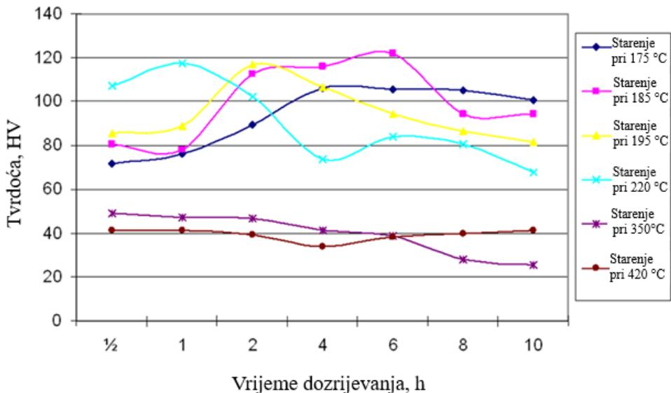
Slika 3.16 Dijagram ovisnosti tvrdoće o vremenu dozrijevanja aluminijeve legure 6061-T6 pri različitim temperaturama dozrijevanja [20]
