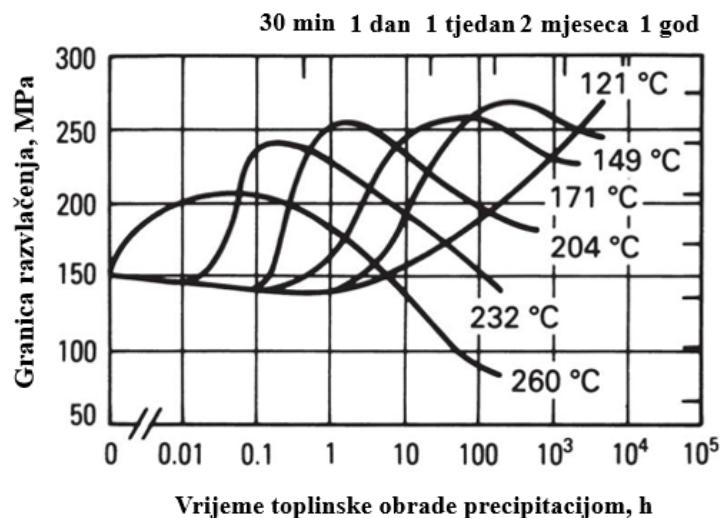
Slika 3.4 Krivulje umjetnog dozrijevanja toplinski obradene i gašene aluminijeve legure 6061 [2]
