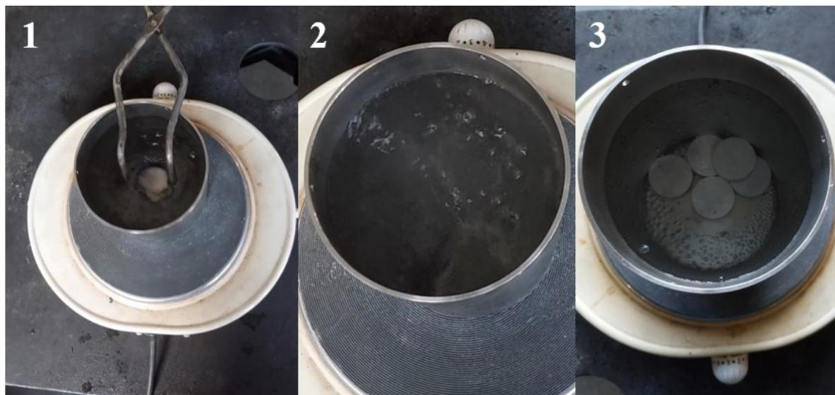
Slika 5.8 Gašenje uzorka s vidljivim prisutnim fazama
