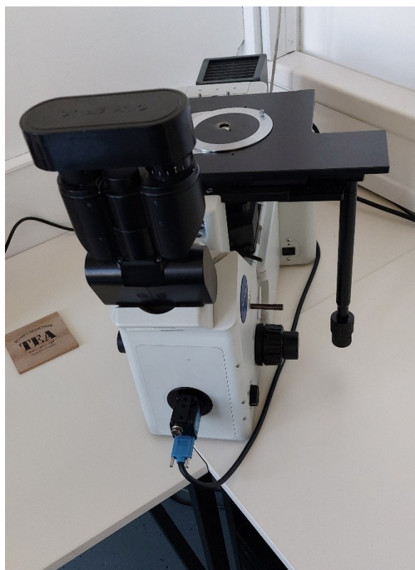
Slika 6.16 Svjetlosni mikroskop Olympus GX51
