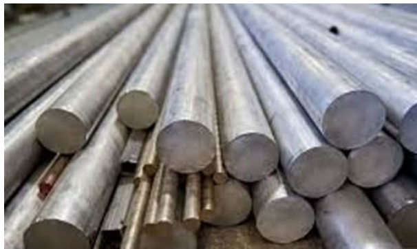
Slika 2.3 Šipke od kovane aluminijske legure 6061 T6 [6]
