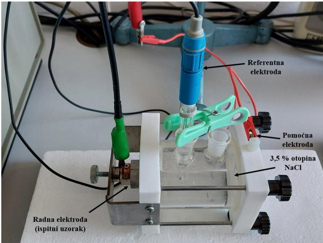
**Slika 5.16 Elektrokemijska čelija s dijelovima u trenutku ispitivanja**
