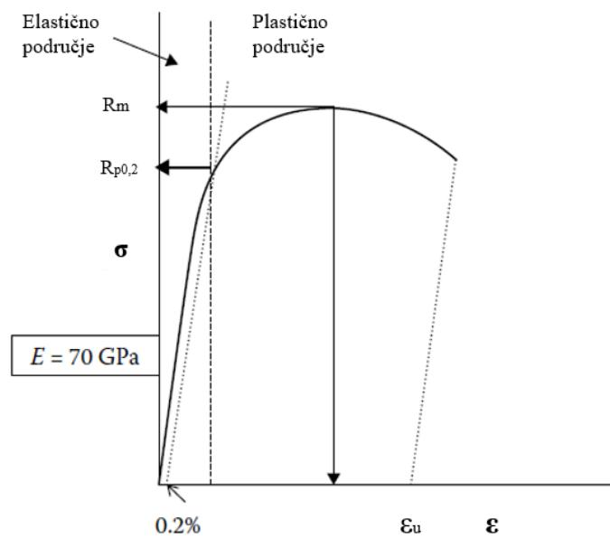
Slika 2.4 Dijagram naprezanje - istezanje kod aluminijevih legura [1]
