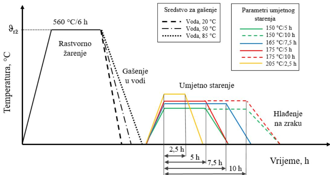
**Slika 5.6 Shematski prikaz toplinske obrade ispitivanih uzoraka**
