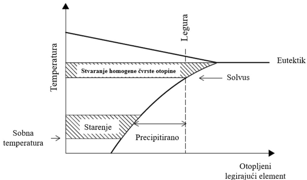
**Slika 3.1 Shematski prikaz faznog dijagrama toplinski obradivih aluminijevih legura [1]**
