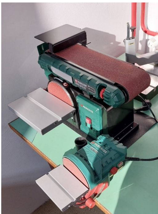
Slika 5.4 Tračna brusilica pomoću koje su brušene površine uzoraka
