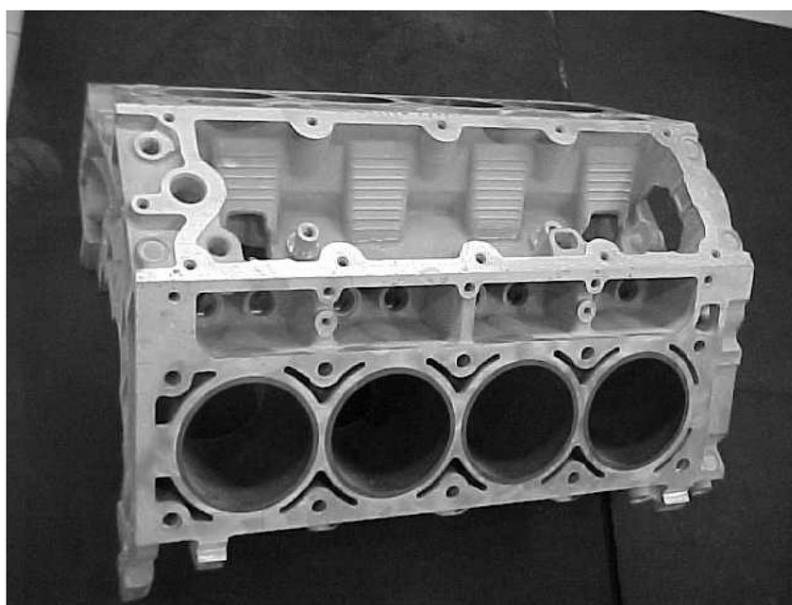
Slika 2.2 Blok motora V8 od lijevane legure aluminijske A319 AlSiCu [5]
