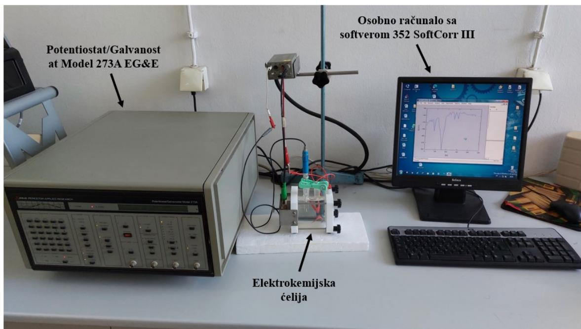
Slika 5.15 Ispitna aparatura za ispitivanje otpornosti na koroziju
