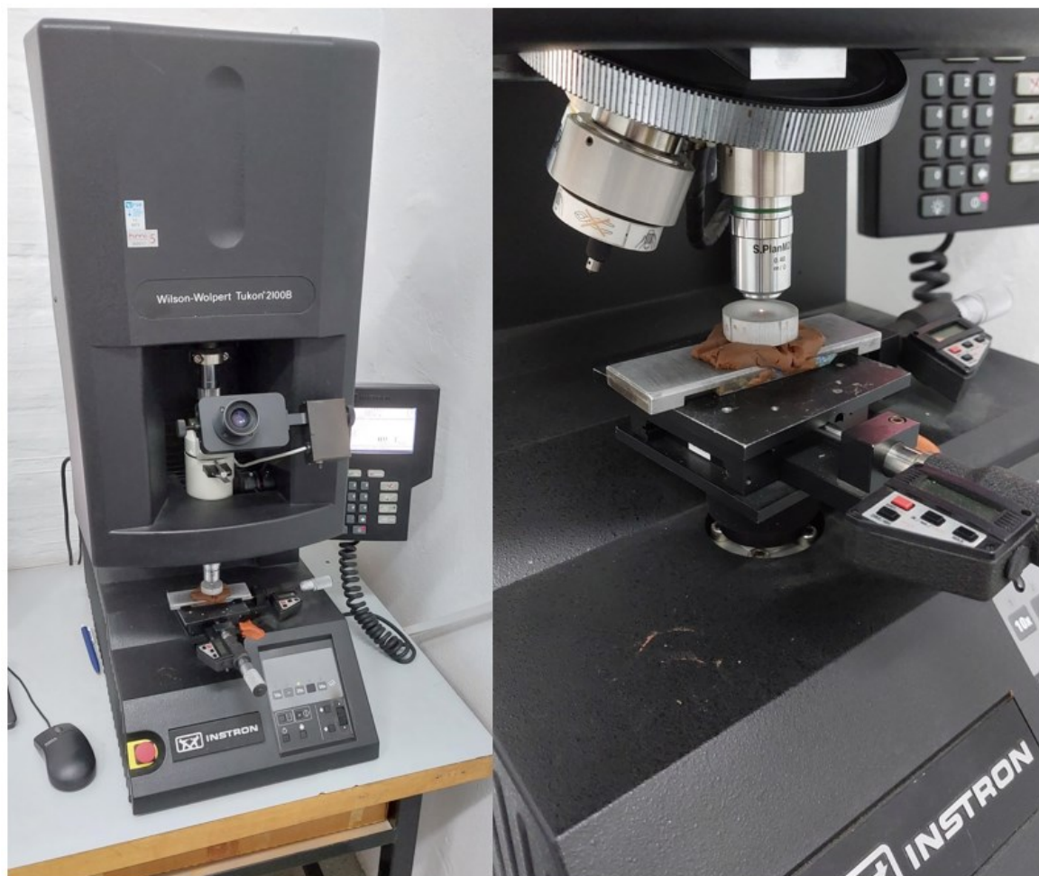
Slika 5.13 Tvrdomjer INSTRON Wilson-Wolpert Tukon 2100B (lijevo) te pripremljeni uzorak za ispitivanje tvrdoće na uređaju (desno)
