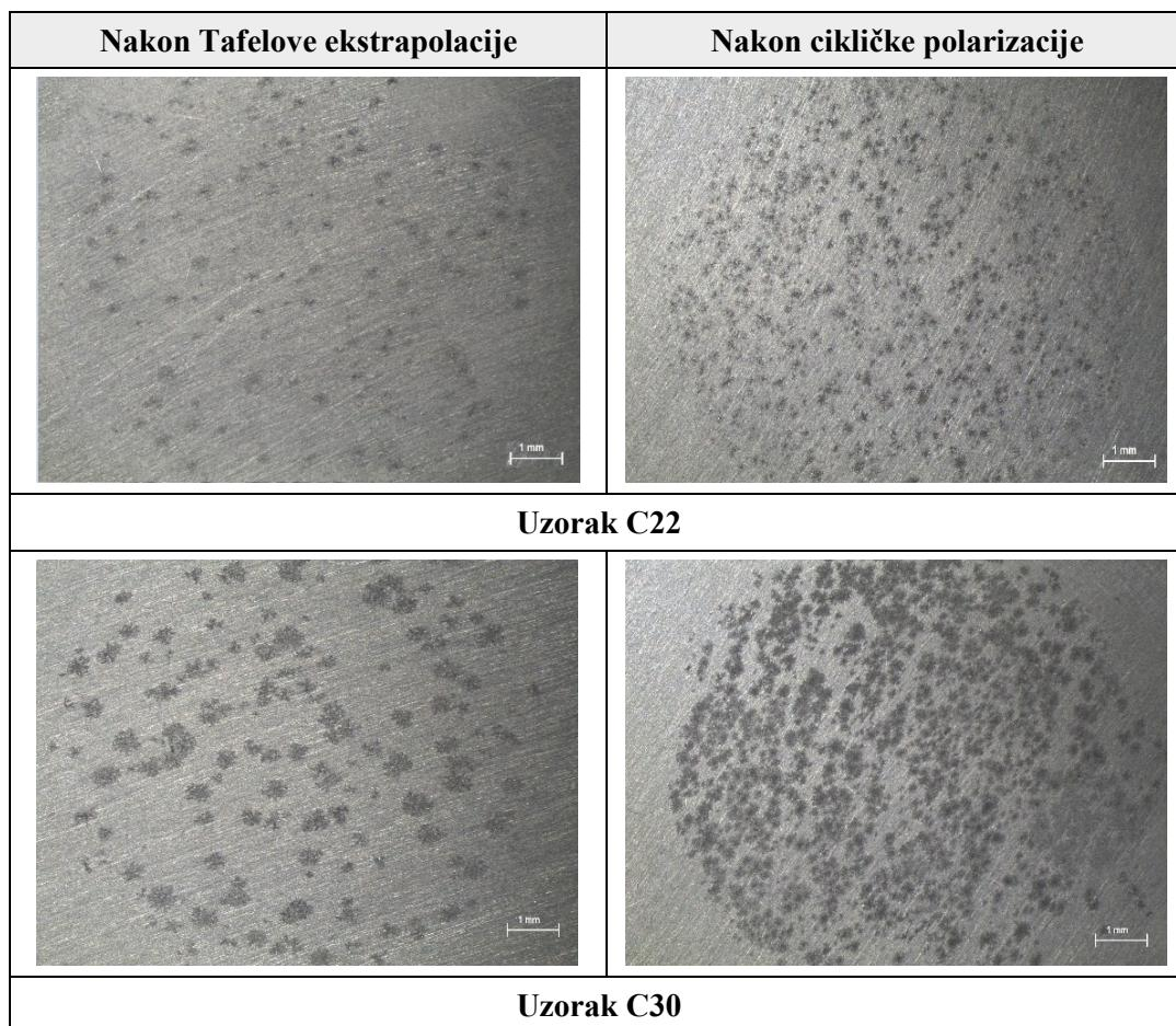
Analizom korodirane površine snimljene stereomikroskopom, na svim uzorcima je uočena lokalizirana rupičasta korozija, pri čemu je ona na nekim uzorcima više, a kod nekih manje izražena. Vidljivo je da je na mnogim uzorcima došlo do intenzivne korozije što je posljedica velike agresivnosti vodene otopine 3,5 % NaCl. Ona sadrži kloridne ione koji prouzrokuju pucanje pasivnog oksidnog filma na površini uzorka.
