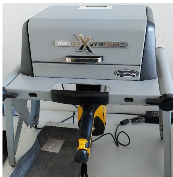
Slika 5.1 Prijenosni uređaj za analizu kemijskog sastava Olympus XRF
