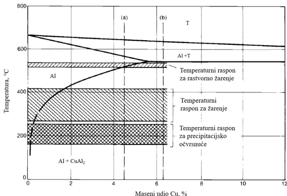
Slika 3.13 Binarni dijagram Al-Cu s temperaturama toplinske obrade [7]
