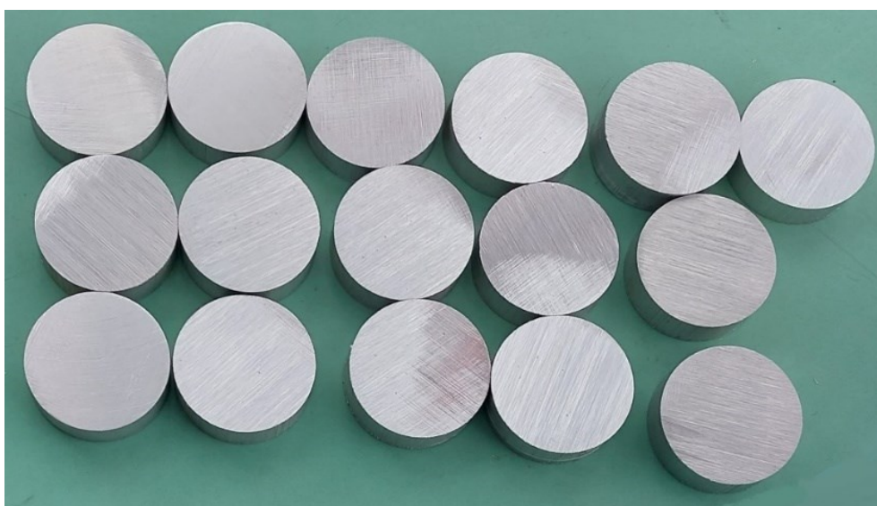
Slika 5.3 Izrezani uzorci prije pripreme površina za ispitivanja
