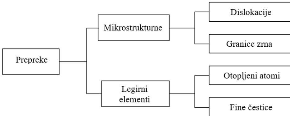
**Slika 2.5 Osnovni tipovi nesavršenosti u mikrostrukturi aluminija [1]**
