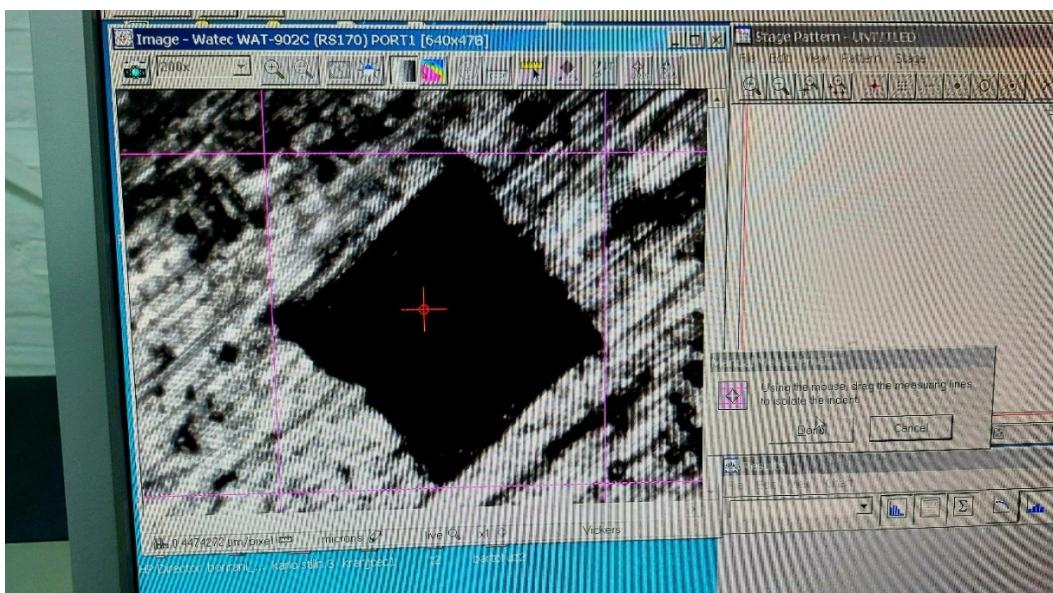
Slika 5.14 Označene dimenzije, tj. diagonale otiska za određivanje tvrdoće u softveru
