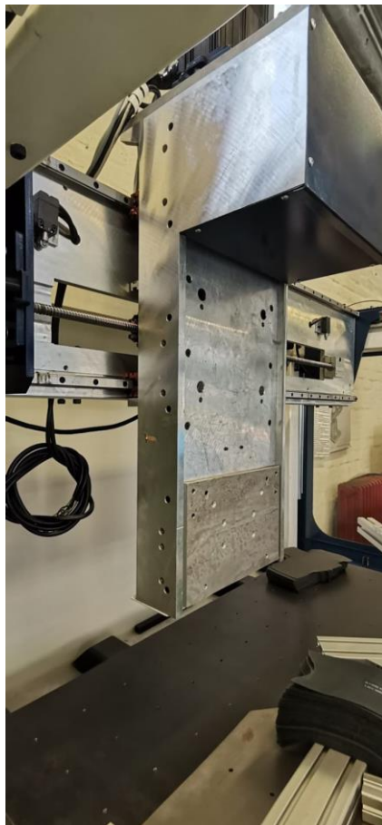
Slika 36. Z os glodalice
