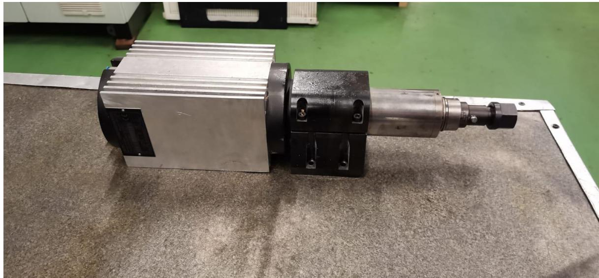
**Slika 34. Motorvreteno HSTEC**
