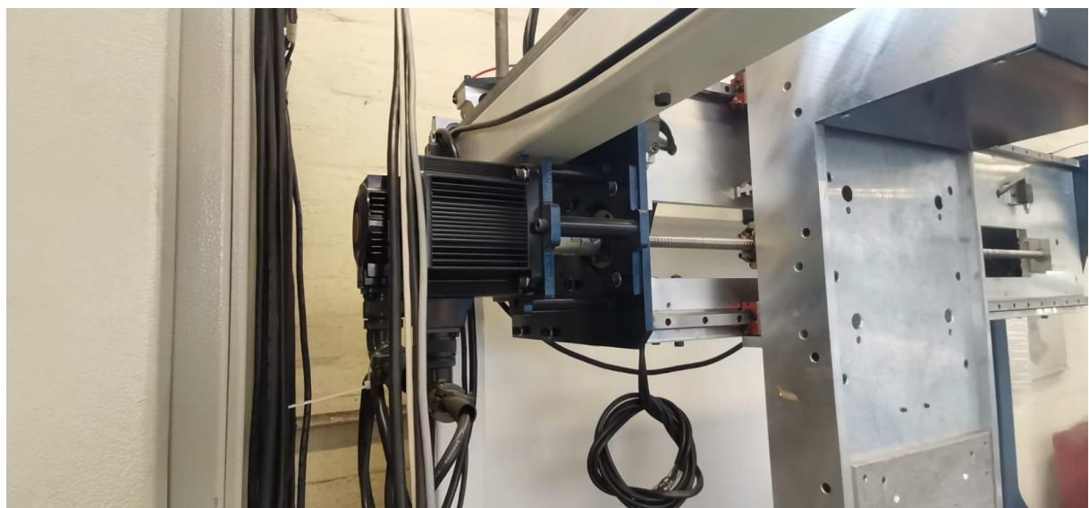
**Slika 33. Servomotor EMG-10ASA22**
