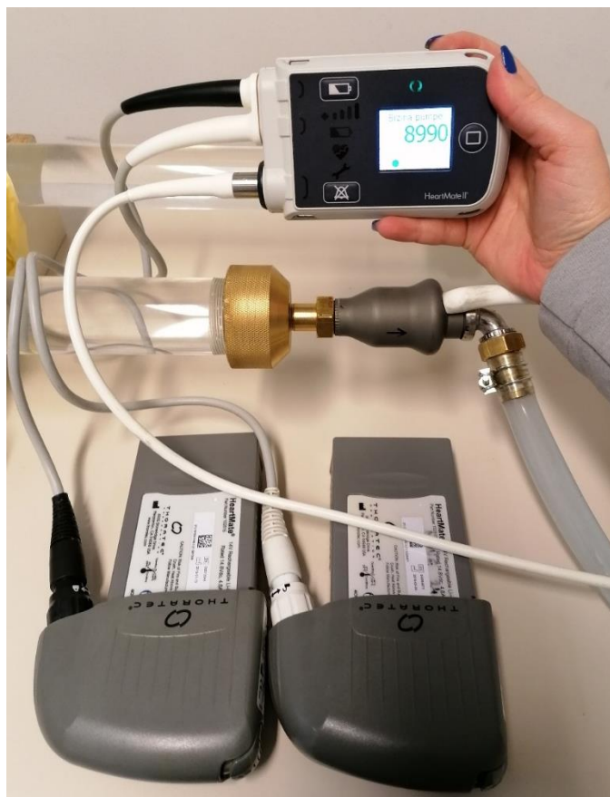
Slika 12. HeartMate II sa upravljačkom jedinicom i baterijama
