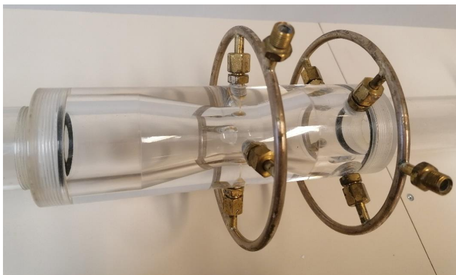
Slika 17. Venturimetar od pleksi stakla
