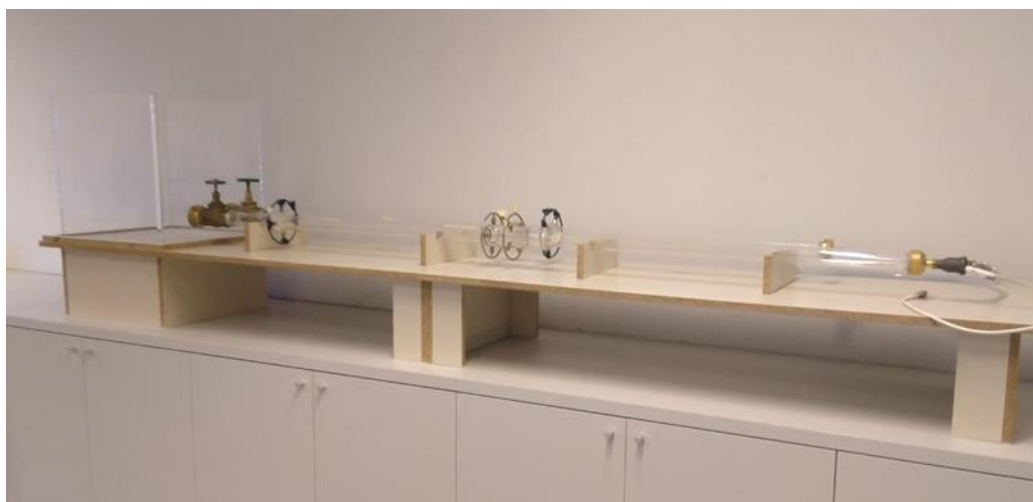
Slika 14. Mjerna staza za ispitivanje srčane pumpe
