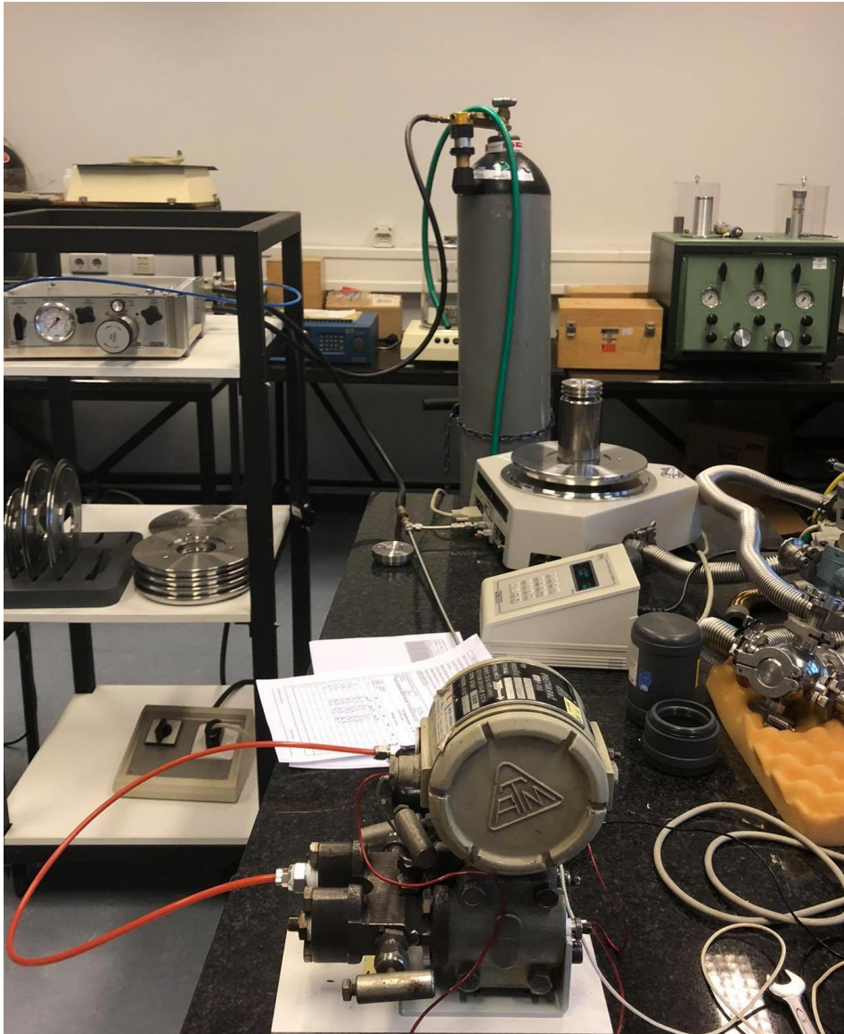
Slika 18. Umjeravanje tlačnom vagom TLVAG 09
