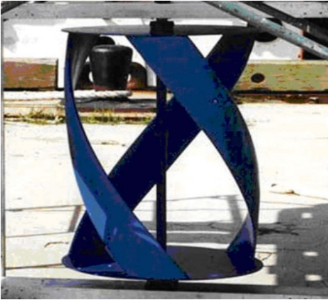
Slika 5. Gorlov spiralna plimna turbina
