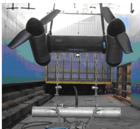
Slika 9. TidEl plimna turbina
