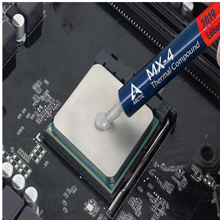
Slika 1.1: Primjer nanošenja toplinske paste na procesor [1]
