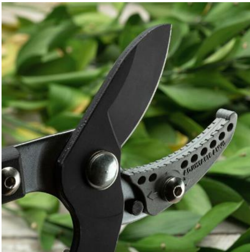
Slika 3. Nakovanjske (anvil) oštrice
