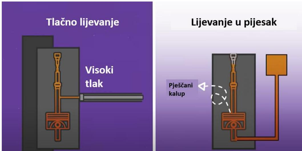
Slika 14. Prikaz tlačnog lijevanja i lijevanja u pijesak [16]
