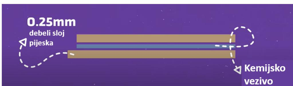
Slika 15. Postupak 3D-printanja pješčanog kalupa [16]
