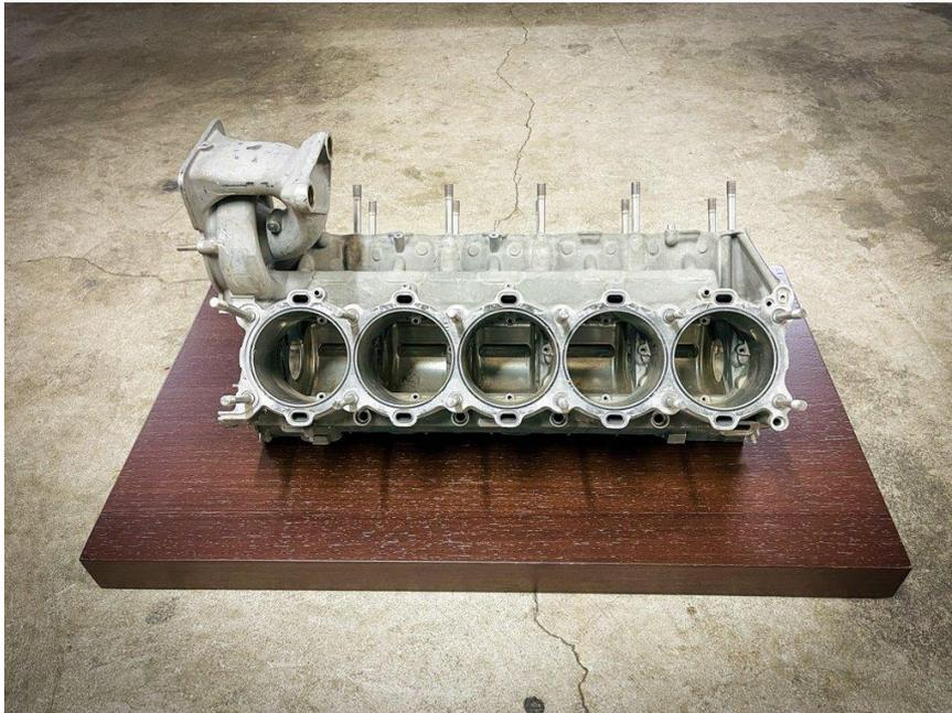
**Slika 13. Blok motora Formule 1 [15]**
