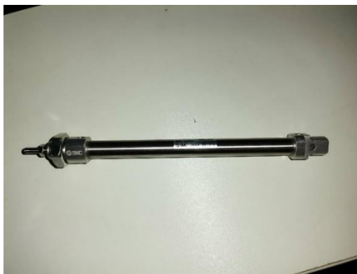
Slika 3.2 Dvoradni cilindar C85E10-100
