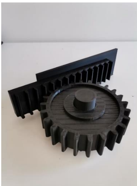
Slika 4.3 Isprintan mehanizam za pokretanje vrata
