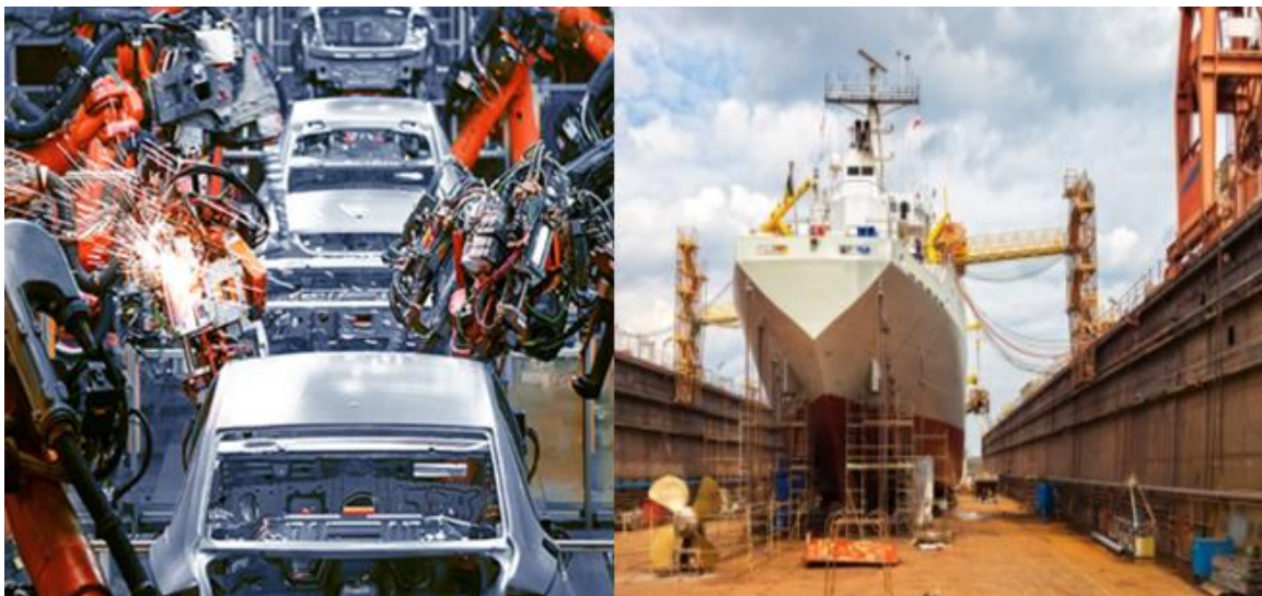
Slika 5. AC MIG zavarivanje u automobilskoj i brodskoj industriji [9]
