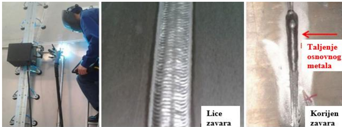
Slika 1. Automatizirani postupak DC impulsnog MIG zavarivanja trupa jedrilice od aluminija i problemi kod zavara [5]
