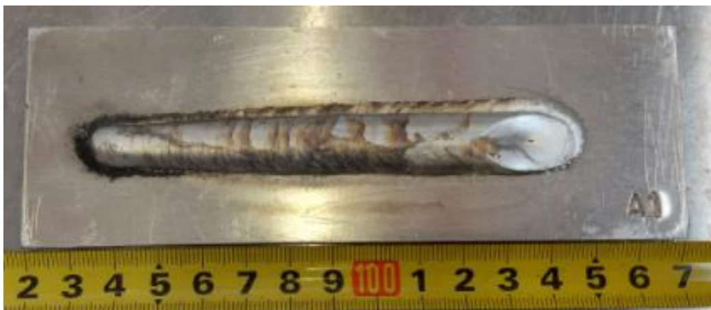
Slika 28. Uzorak A1 - istosmjerna struja, I = 150 \text{ A} , U = 22,8 \text{ V}
