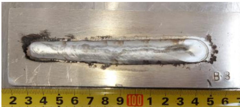
Slika 31. Uzorak B3 - izmjenična struja, I = 180 \text{ A} , U = 24,8 \text{ V} , f = 136,4 \text{ Hz} , EN = 0 \%
