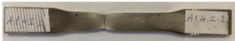
Slika 18. Epruveta poslije ispitivanja
