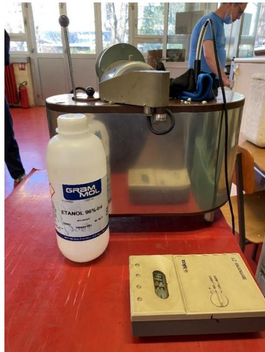
Slika 23. Sustav za ohlađivanje ispitnih uzoraka
