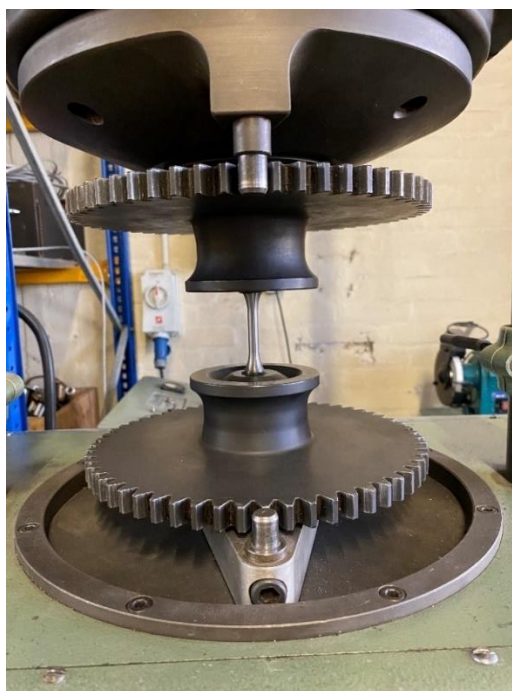
Slika 33. Prihvatni sustav za epruvetu na umaralici
