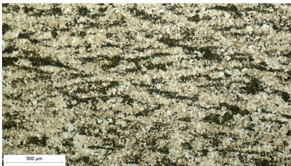
Slika 29. Mikrostruktura poprečno na smjer valjanja
