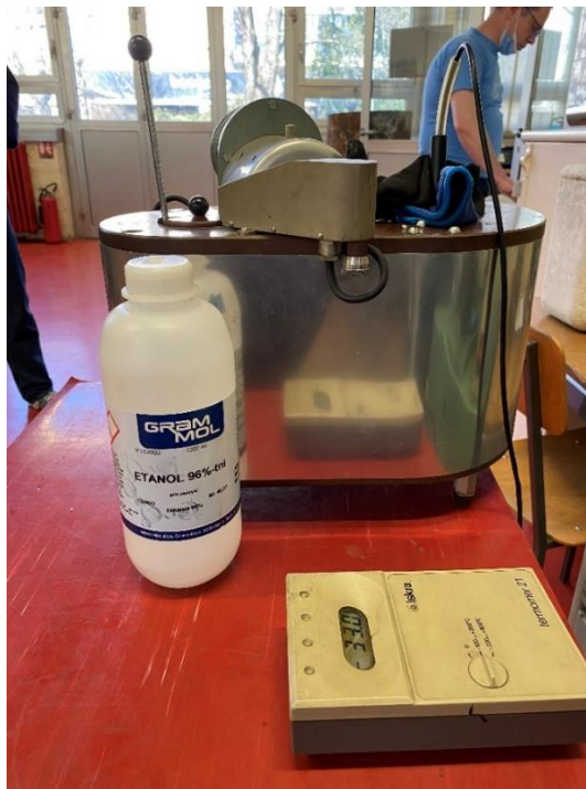
Slika 23. Sustav za ohlađivanje ispitnih uzoraka
