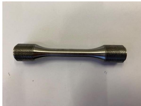
Slika 32. Epruveta za dinamičko ispitivanje
