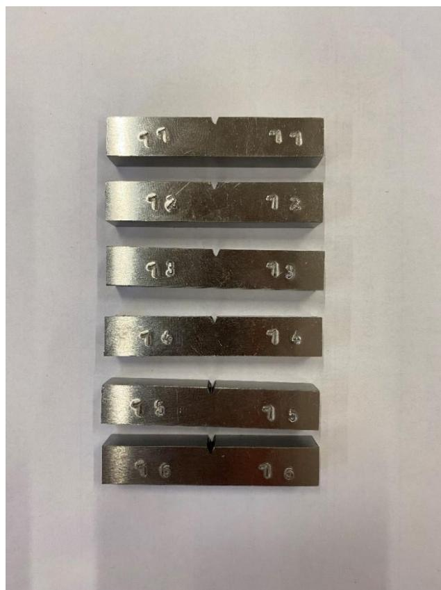
Slika 24. Epruvete prije ispitivanja
