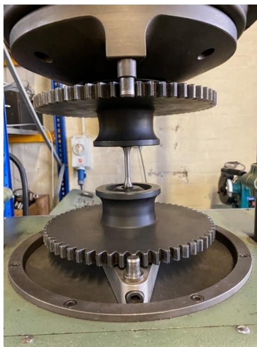
Slika 33. Prihvatni sustav za epruvetu na umaralici
