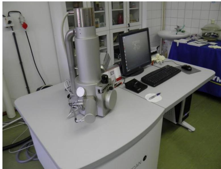
**Slika 35. Skenirajući elektronski mikroskop Tescan Vega**
