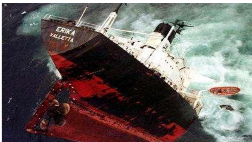
Slika 11. Potonuće tankera Erika uslijed oslabljenja trupa korozijom [18]
