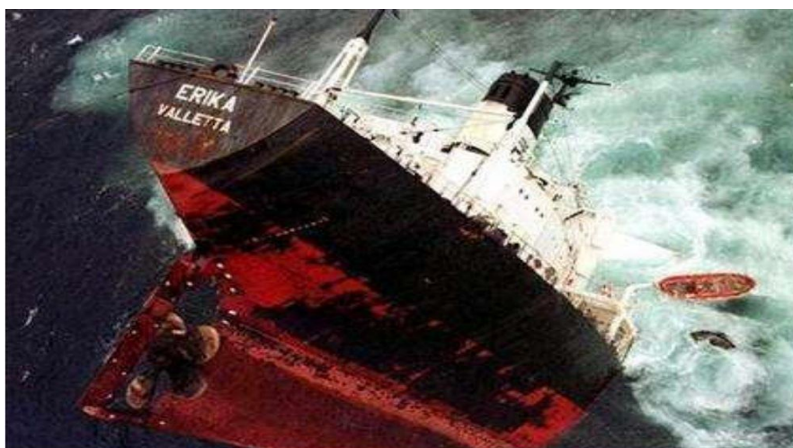
Slika 11. Potonuće tankera Erika uslijed oslabljenja trupa korozijom [18]
