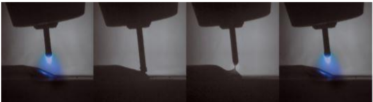
Slika 6. Faze Cold Metal Transfer postupka [10]
