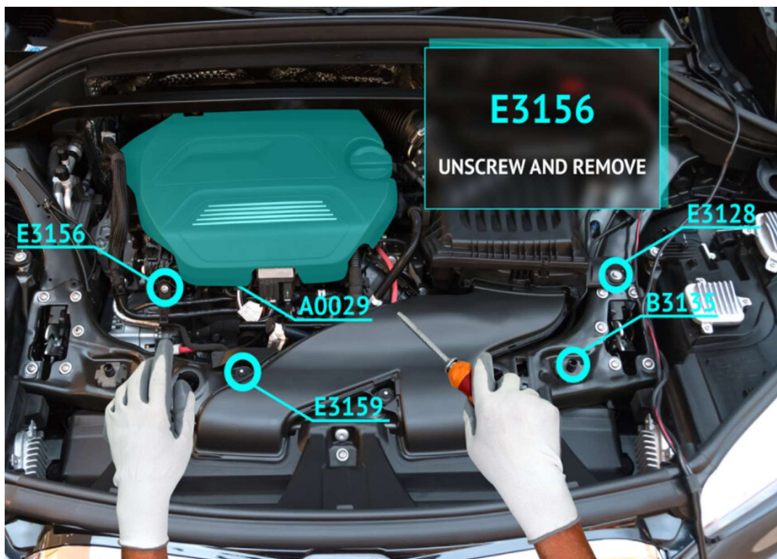
Slika 17. Primjena proširene stvarnosti pri demontaži automobila [24]
