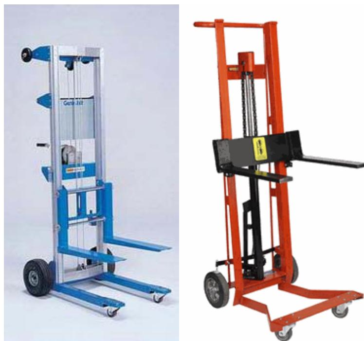
Slika 5. Podizni viličar mehanički/hidraulički
