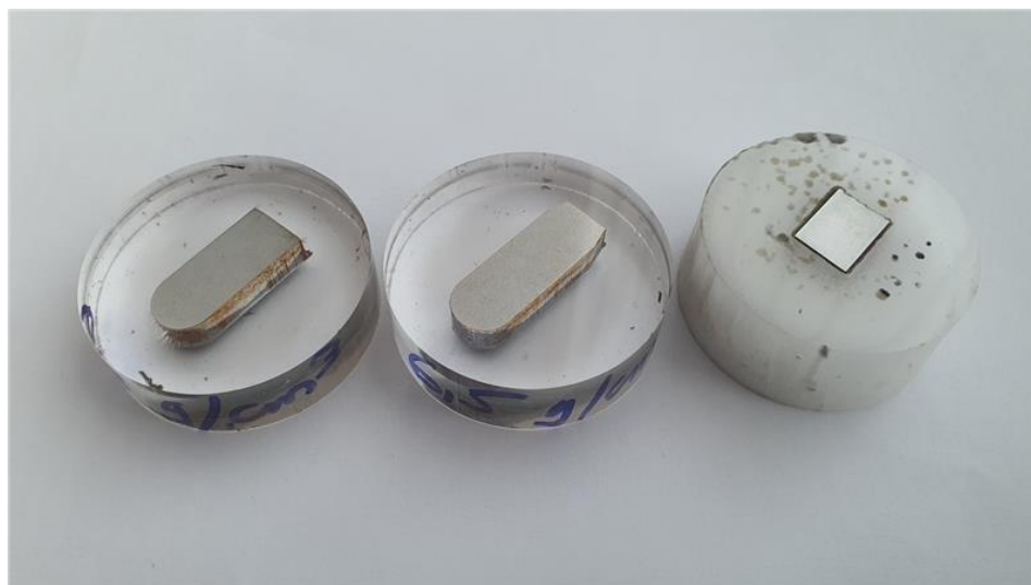
Slika 19 Uzorci sinteriranog čelika Astaloy Mo+0,2C
