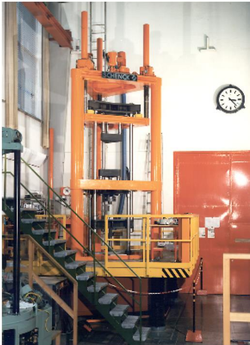
Slika 5. Primarni etalon za silu nazivne sile 1MN, PTB, Njemačka [13]
