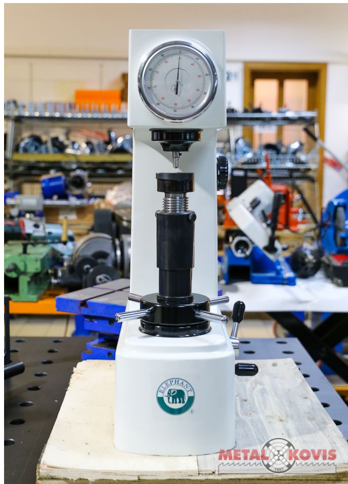
Slika 16. Uređaj za mjerenje tvrdoće Rockwell metodom [16]
