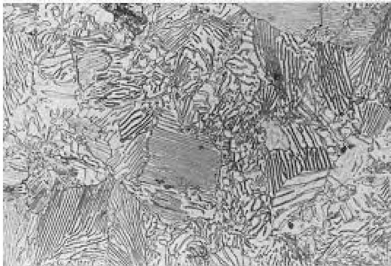
Slika 3. Mikrostruktura poboljšanog čelika [8]
