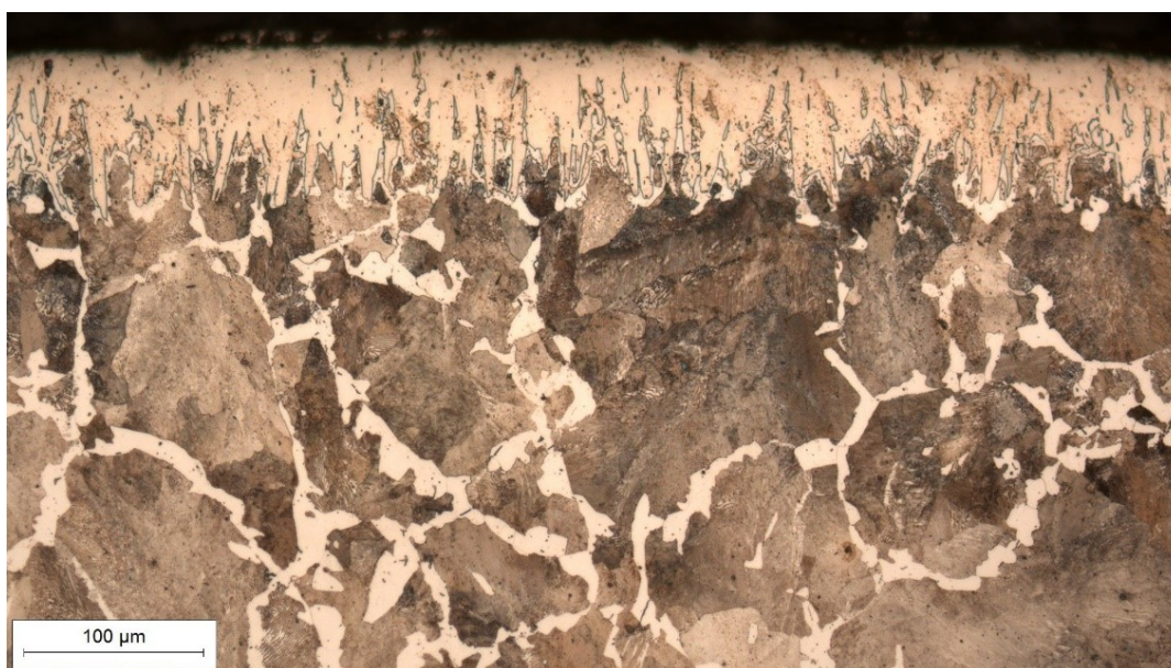
Slika 23. Borirani uzorak, uvećanje 200x
