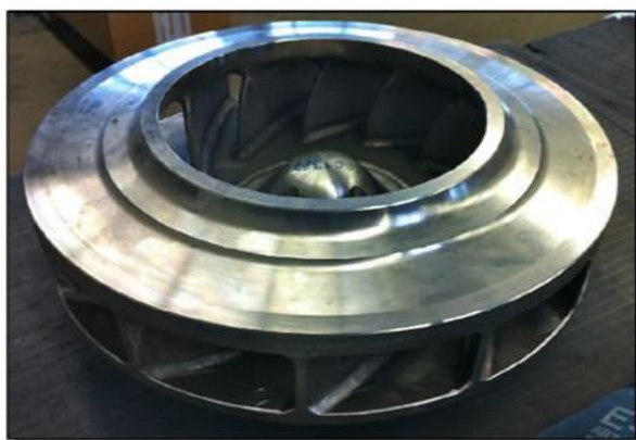
Slika 6. Borirani dio pumpe [19]
