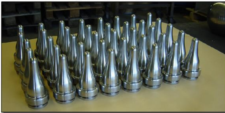
Slika 9. Borirani dijelovi u industriji stakla [19]
