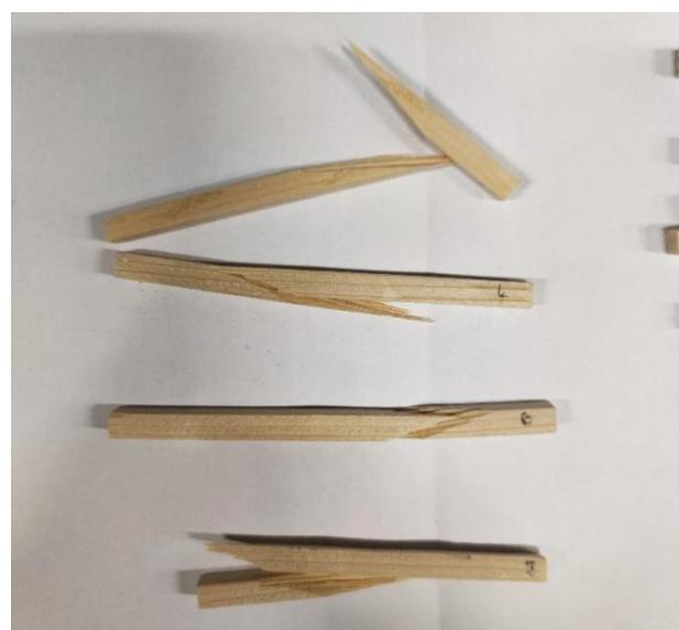
**Slika 40. Ispitni uzorci iz skupine L45 nakon ispitivanja**
