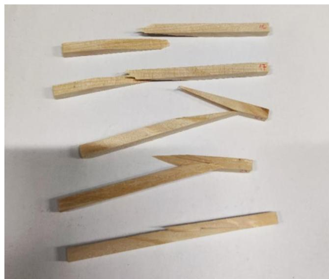
**Slika 42. Ispitni uzorci iz skupine L90 nakon ispitivanja**
