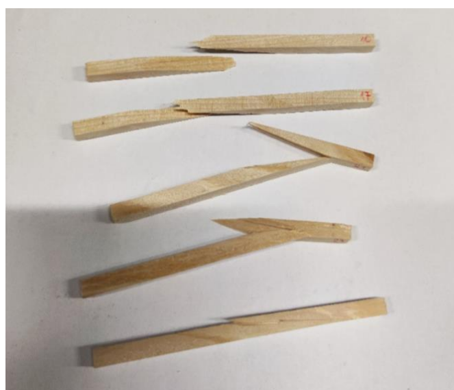
Slika 42. Ispitni uzorci iz skupine L90 nakon ispitivanja
