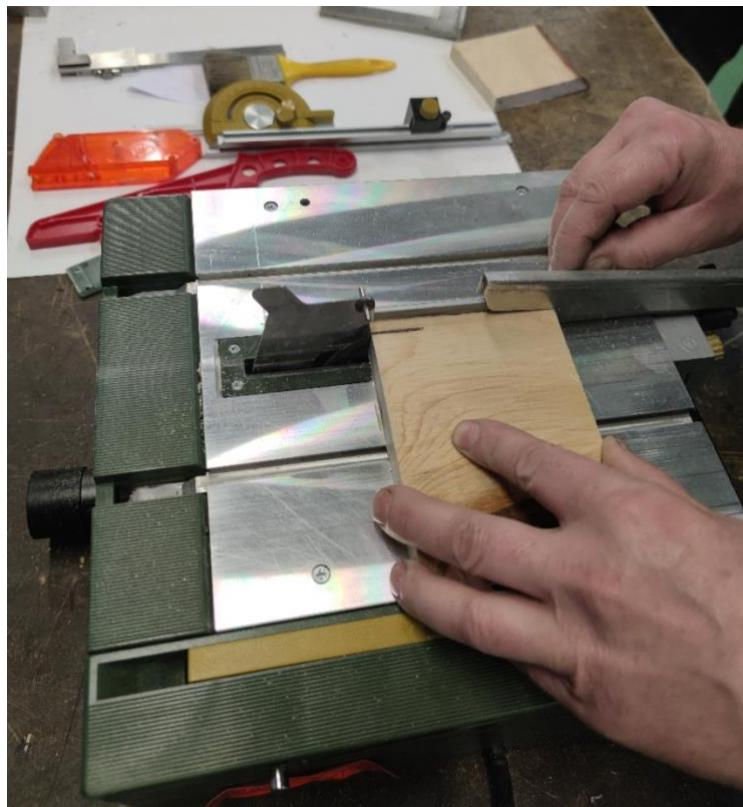
Slika 32. Precizno izrezivanje uzorka
