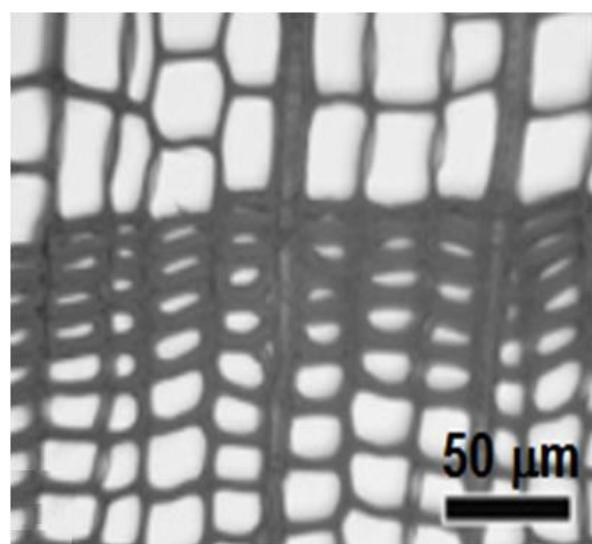
Slika 15. Poprečni presjek traheida kasnog i ranog drva [6]
