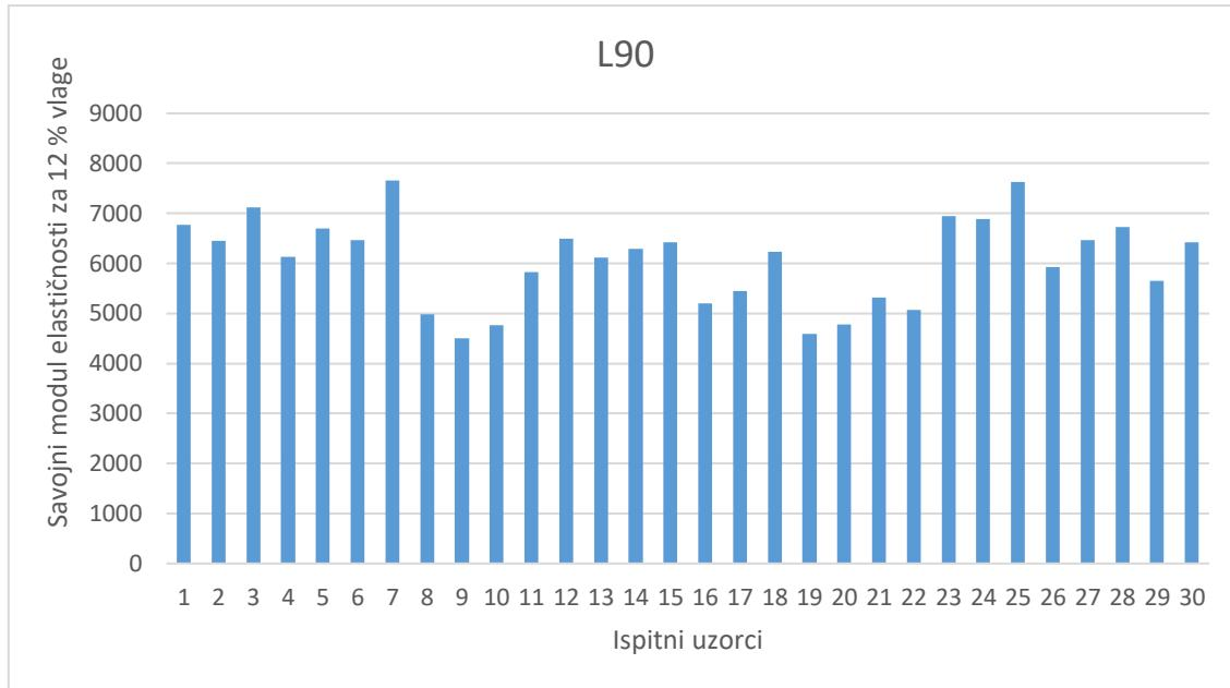
**Slika 41. Vrijednosti savojnog modula elastičnosti uzorka L90**
