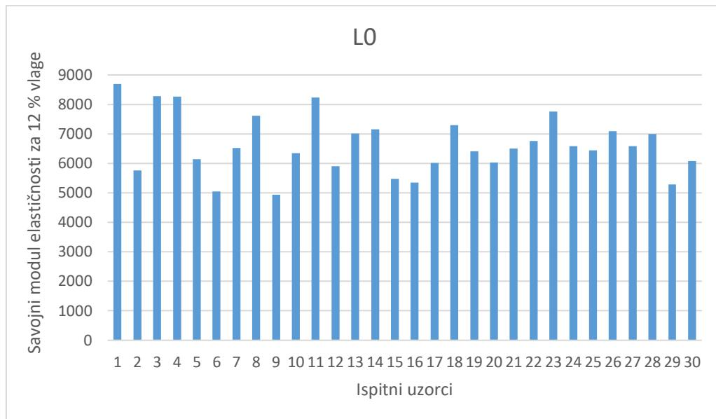
**Slika 37. Vrijednosti savojnog modula elastičnosti uzorka L0**
