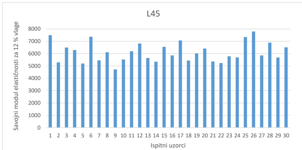
**Slika 39. Vrijednosti savojnog modula elastičnosti uzorka L45**
