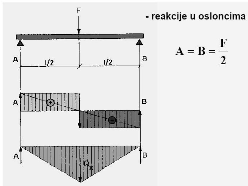
**Slika 21. Prikaz djelovanja savojne sile kod metode savijanja u tri točke**
