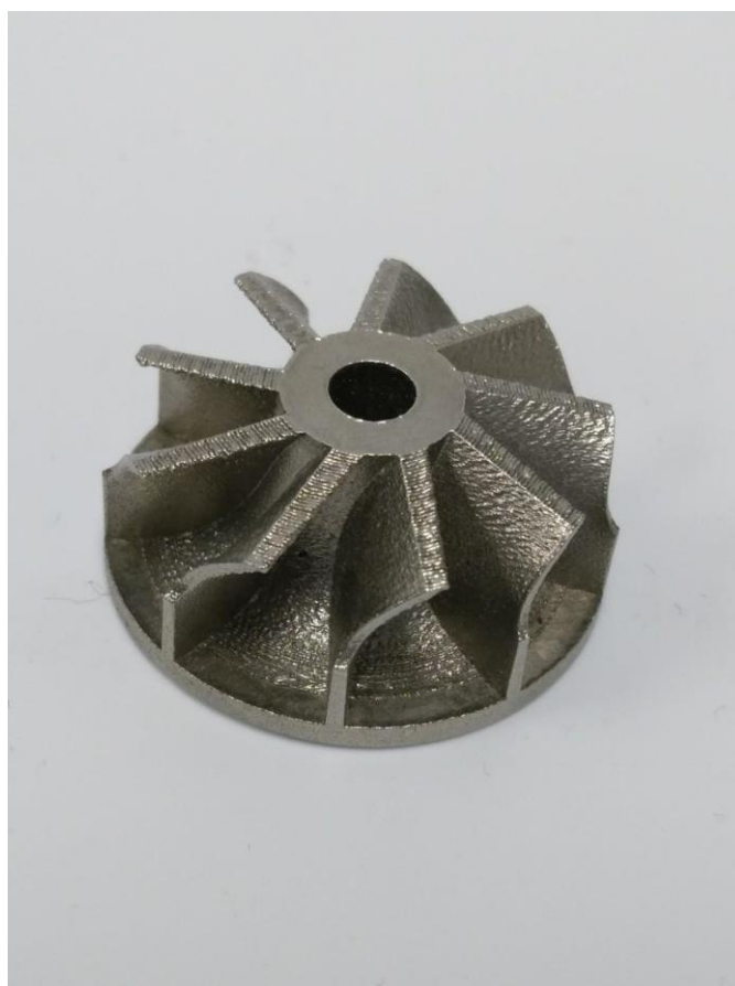
Slika 1. Primjer predmeta (impeler) dobivenog aditivnom proizvodnjom [2]
