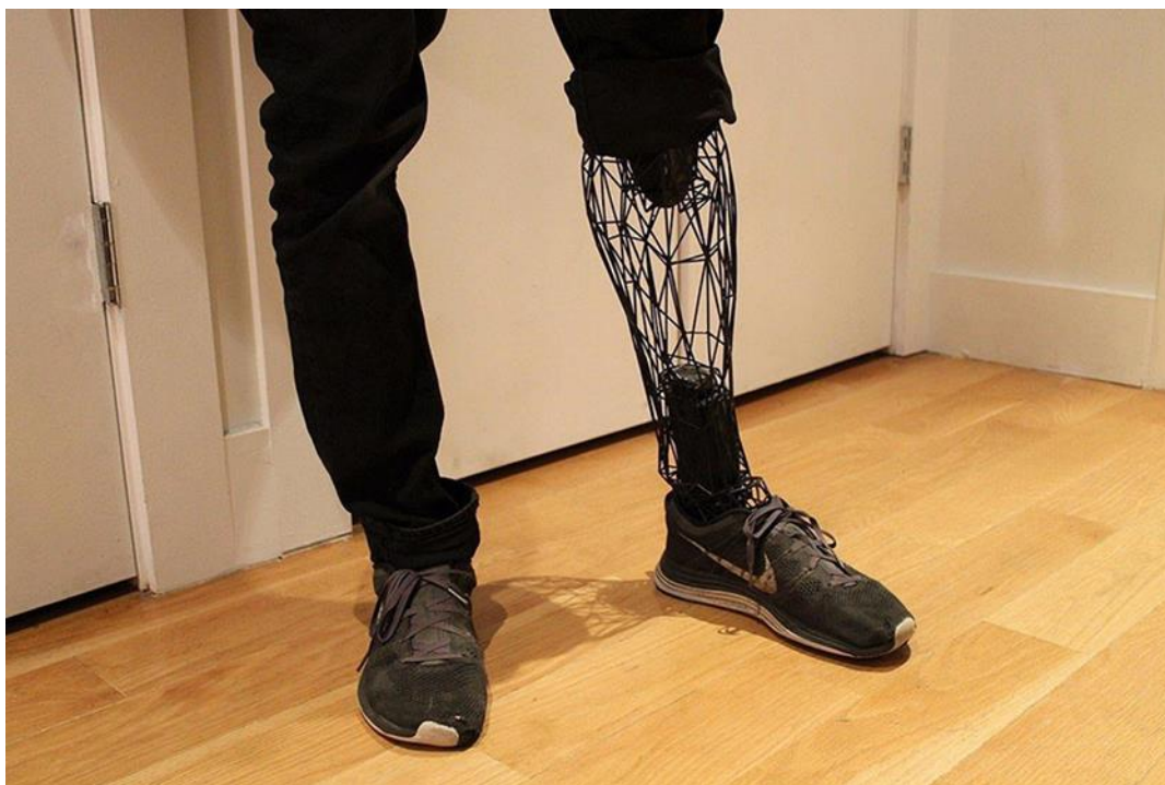
Slika 11. Nožna proteza izrađena aditivnom tehnologijom [15]
