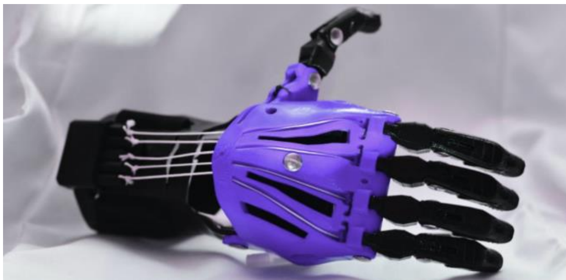
Slika 12. Jeftina proteza ruke izrađena na kućnom 3D pisaču [16]
