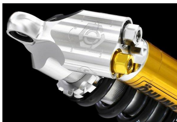
Slika 1.5. Öhlins TTX 25 - podešavanje [4]
