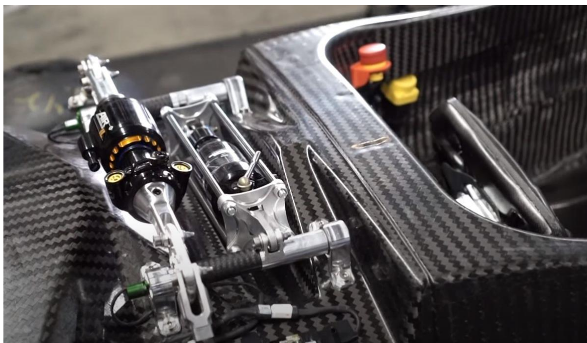
Slika 2.3. Primjer pushrod mehanizma 2 [9]
