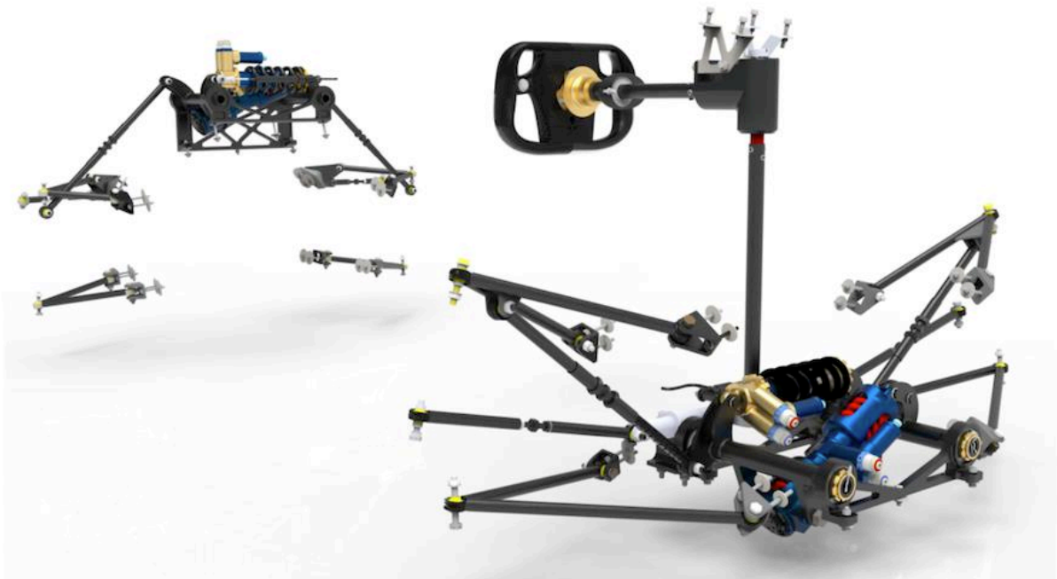
Slika 1.12. Primjer raspregnutog ovjesa bolida Formula Student [8]
