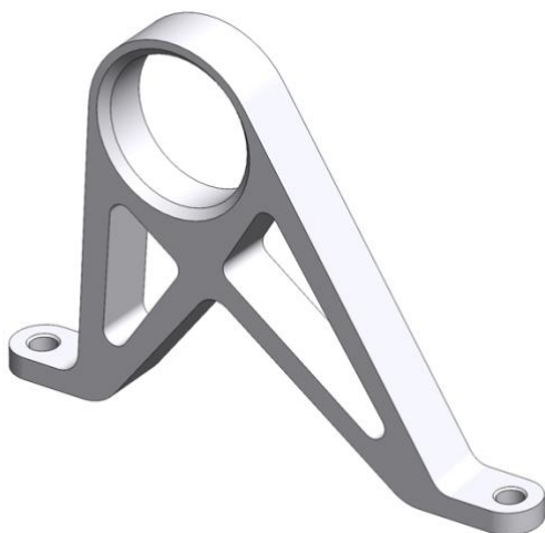
Slika 4.12. Prednji nosač klackalice u pushrod mehanizmu
