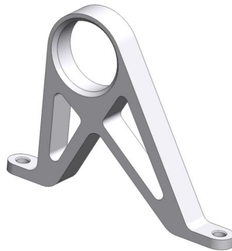
Slika 4.11. Stražnji nosač klackalice u pullrod mehanizmu
