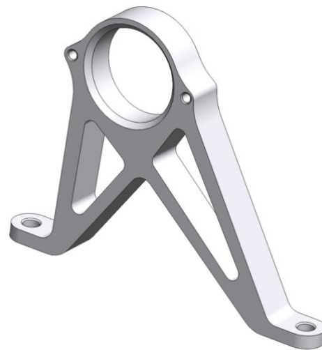
Slika 4.13. Stražnji nosač klackalice u pushrod mehanizmu
