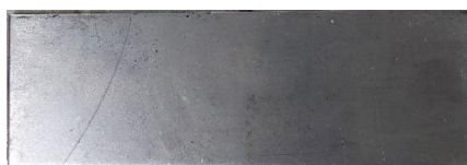
Slika 17. Uzorak za ispitivanje prionjivosti premaza
