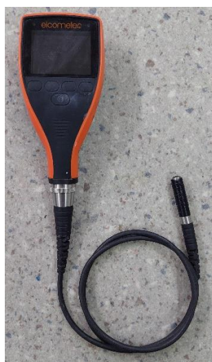
Slika 25. "Elcometer" uređaj za mjerenje debljine prevlake
