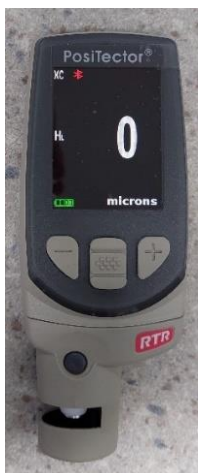
Slika 20. Uređaj za mjerenje hrapavosti površine Positector RTR
