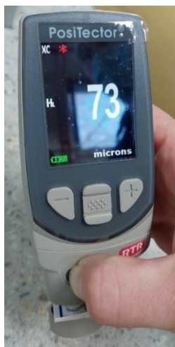
Slika 22. Mjerenje hrapavosti na uređaju Positector RTR
