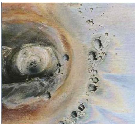
Slika 5. Primjer rupičaste korozije [10]
