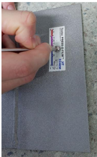
Slika 21. Postupak utiskivanja trakice na površinu uzorka
