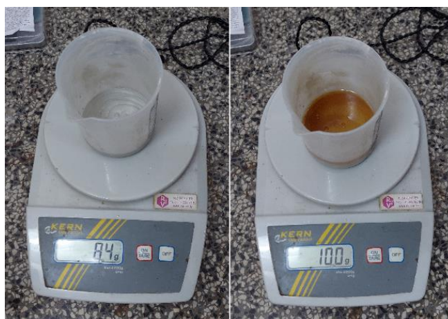
Slika 23. Priprema mješavine premaza
