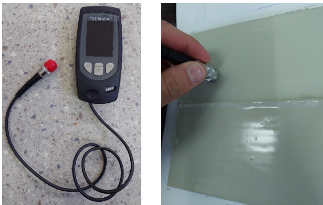
Slika 28. Mjerenje debljine prevlake uređajem „Positector 6000“
