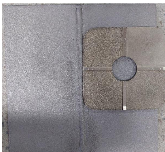
Slika 19. Usporedba pjeskarene površine s komparatorom hrapavosti prema HRN EN ISO 8503-1
