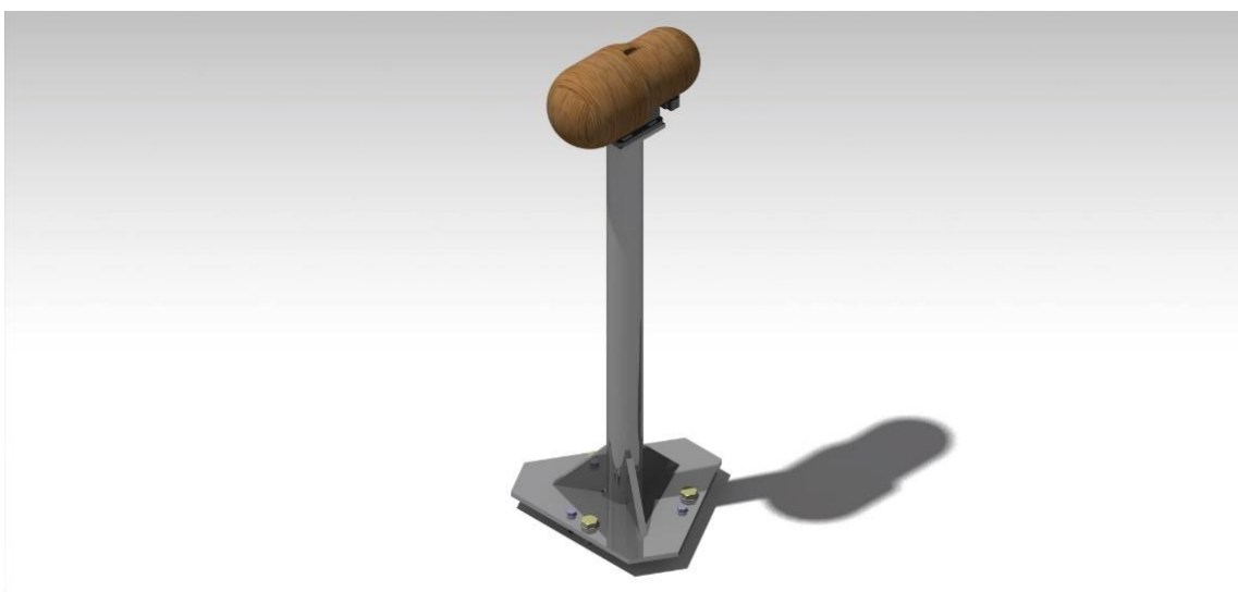
Slika 19. Sklop stezne naprave, senzora sile i obratka [24]
