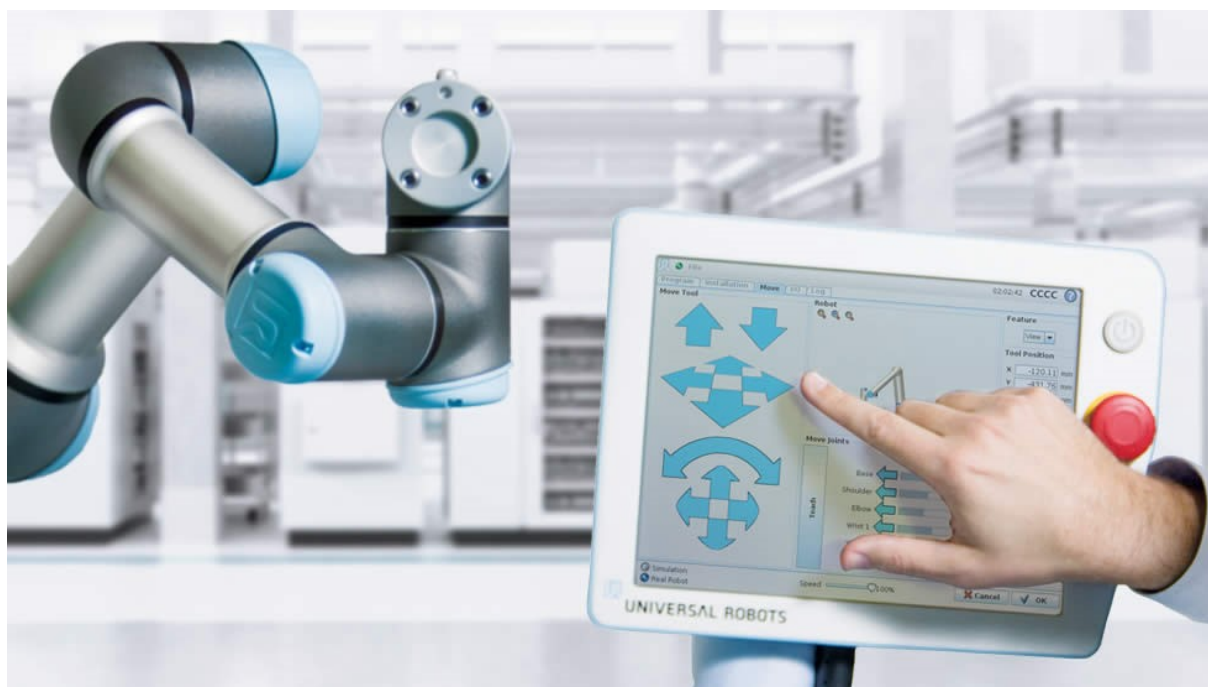
Slika 3.1 Prikaz UR robota i njegovog sučelja za programiranje
