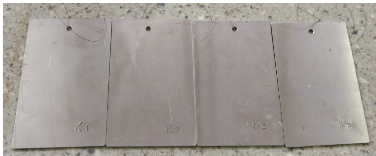
Slika 15. Uzorci obrađeni u kiselini i pasivatoru
