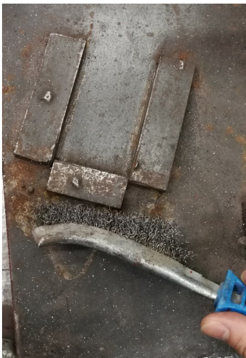
Slika 5. Prikaz ručnog mehaničkog čišćenja metala
