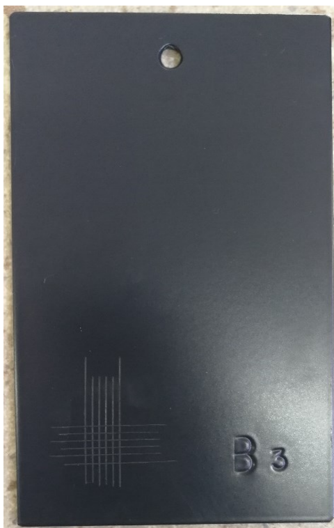
Slika 43. Test prionljivosti na uzorku B3 poslije vlažne komore
