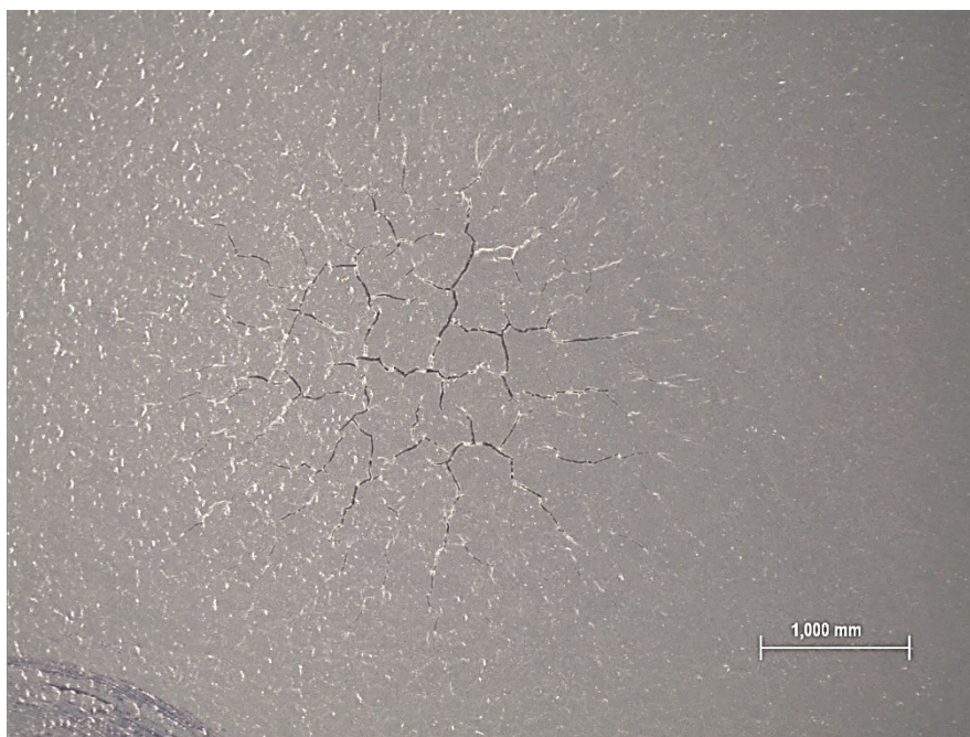
Slika 64. Uzorak K3 - ne zadovoljava; visina s koje je pušten uteg pri kojoj prevlaka nije zadržala svoja svojstva kao ni mikro i makro konzistentnost iznosi 5 cm
