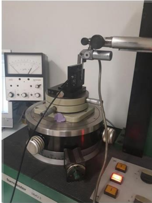
Slika 16. Umjeravanje uređaja za ispitivanje kružnosti piezoelementom [5]
