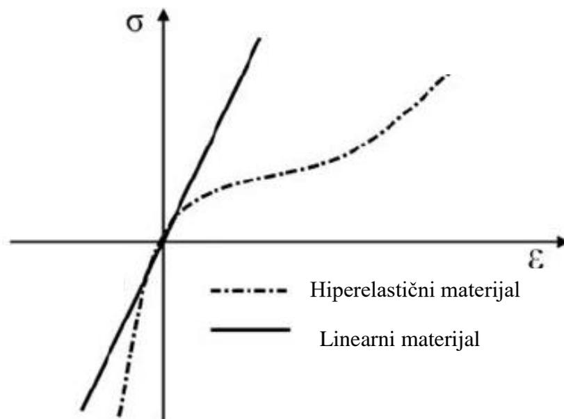
Slika 17. Usporedba linearnog i hiperelastičnog materijala [23]
