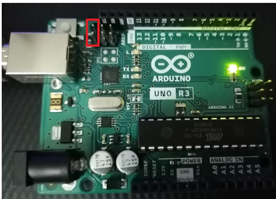
Slika 7.1 Resetiranje Arduino Uno ploče
