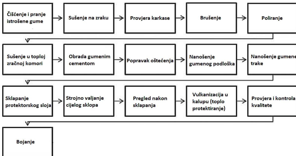
Slika 5.2. Koraci protektiranja istrošene gume [4]
