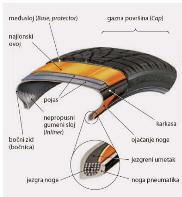
Slika 2.2. Radijalna guma za osobna vozila [8]
